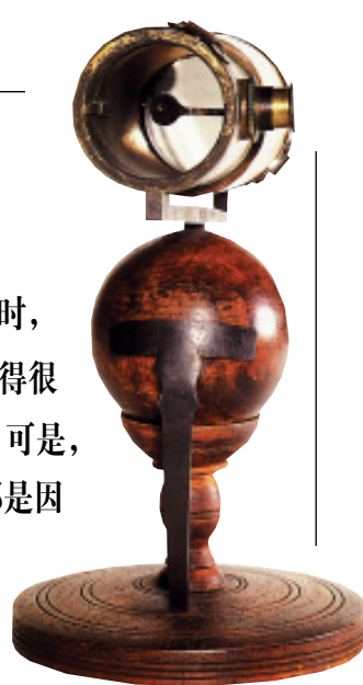
反射式望远镜 牛顿设计的反射式望远镜，底座有一个球状的基座，然后以金属的支架与镜片连接，如此一来，镜筒可以朝任何方向瞄准。
