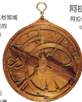
被用于测量星体远近的计算仪器——星盘
