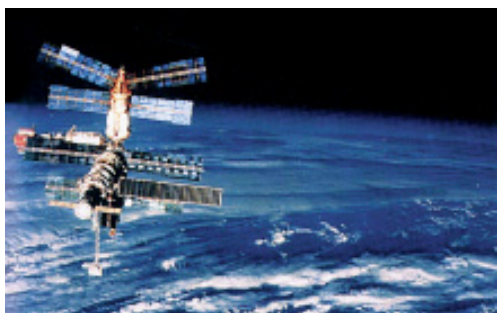
“和平号”是苏联于1986年2月发射的航天站。航天飞机通过航天站的6个对接口之一，将宇航员送入或接出航天站。
