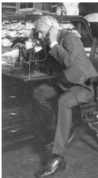
爱迪生晚年仍在改良电话。此时话筒与听筒仍然是分开设计的。
