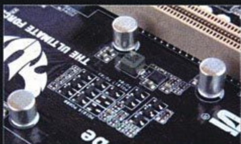
靠独立芯片控制电路实现的E.S.P（高效电能转换）设计
