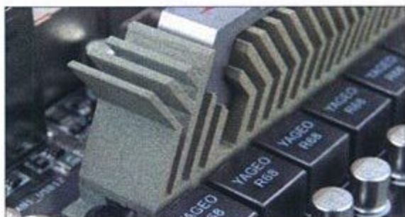
产品的散热片均为陶瓷材质,散热效果极高
