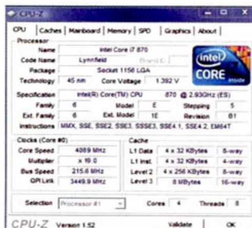
P7P55D轻松将Core i7 870超频到4GHz以上
