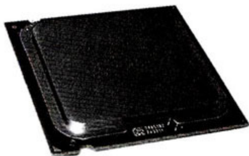
Pentium E5300已经有支持VT技术的型号，编号为SLGTL（老款编号为SLB9U）。
