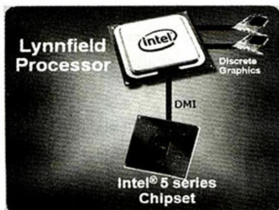
Core i5处理器同主板芯片组连接示意图
