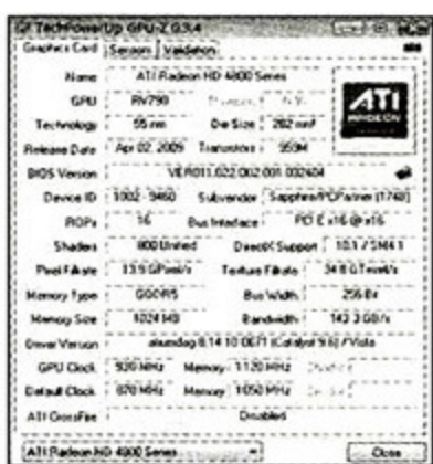
简单超频后, 产品核心/显存频率达到930M/4480MHz
