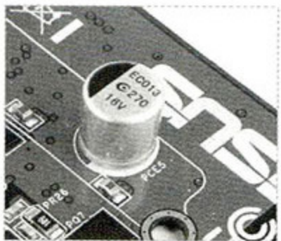
华硕显卡“4U设计理念”中的低电阻场效应管、固态电容、密闭式电感等高品质元件
