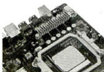
4相处理器供电电路
