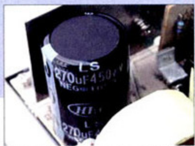
HEC 330uF/450uV高品质滤波电容
