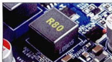
密闭式铁素体电感具有更好的滤波和抗电磁干扰能力
