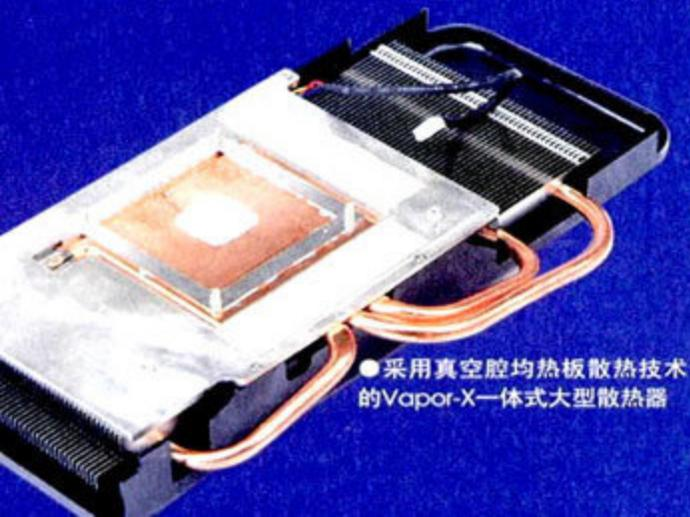
●采用真空腔均热板散热技术的Vapor-X一体式大型散热器
