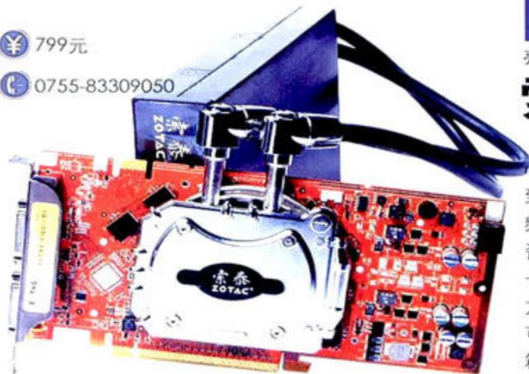
**优** 水冷散热，散热效果好，工作噪音低
