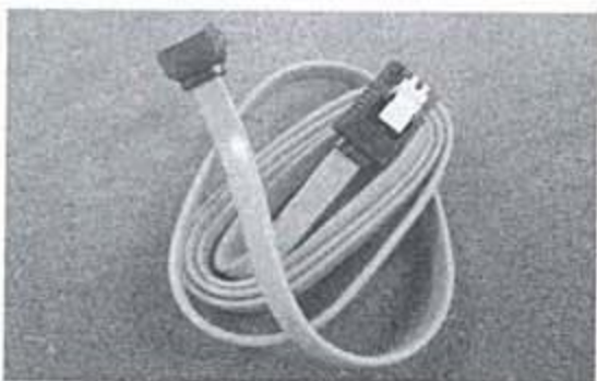
带金属卡扣的SATA数据线，能有效地避免接触不良故障。
