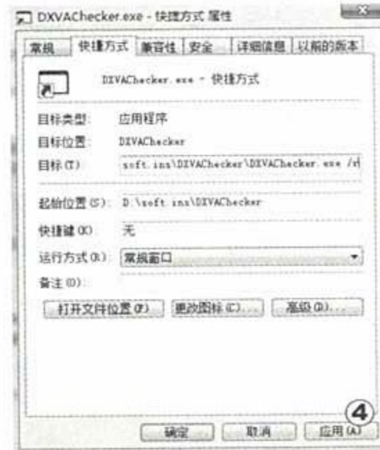
NVIDIA GeForce 6/7系列显卡的用户添加“/r”参数，才能正常运行DXVA Checker。
