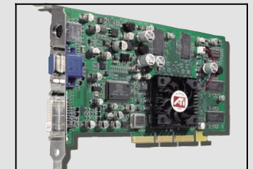
●ATI Radeon 8500 可以说是第一块具备“细分曲面”类似技术的显卡
