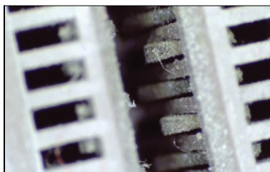
●插槽中的灰尘在显微镜下无所遁形
