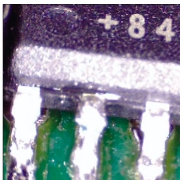
●用显微镜检测芯片焊接质量
