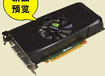
近日 NVIDIA 全球同步发布基于 Fermi 架构第二代 DX11 显卡 GeForce GTX550 Ti,新一代千元内性能王者! GeForce GTX550 Ti 不仅沿用了后缀“Ti”,并且在前置上使用了“GTX”,而非“GTS”,代表着它是一款在这个价位段上,性能无与伦比的 DX11 产品。其配备了 192Bit 显存带宽以及 1GB 显存容量,区别于上代产品 GeForce GTS450,性能上实现了大幅提升,另外用户还能享受 3D Vision、SLI、PhysX、CUDA 等技术支持。
