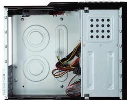
采用类似传统“迷你机箱”的结构,主板和硬盘位分区设置,虽然内部空间宽敞,但也使机箱体积变得更大。
