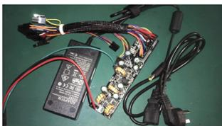
采用外置适配器+内置电源模块的方式,内置电源的用料相当足,能够提供最多120W功率输出,完全满足各种平台的需要。
