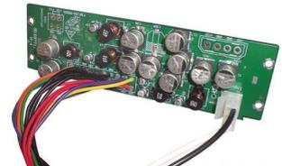
同样是适配器+内置电源的组合。内置电源所用电容虽为铝皮,但实际上是普通电解电容。电源板做工也不敢让人恭维。
