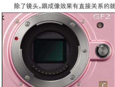
除了镜头,跟成像效果有直接关系的就是相机的感光元件,松下 GF2 的传感器采用 LiveMOS,尺寸为 17.3×13 毫米,相对于 35mm 胶片的折算率为 2 倍。而 550D 采用 CMOS 传感器,尺寸为 22.3×14.9 毫米,折算率为 1.6 倍。可见,550D 传感器的尺寸比 GF2 传感器尺寸要大不少。画面的细节还原能力,显然是传感器尺寸更大的设备成像效果更好。同时,传感器尺寸更大的相机,景深更浅,拍摄人像时,主体会非常突出,背景能充分虚化。
