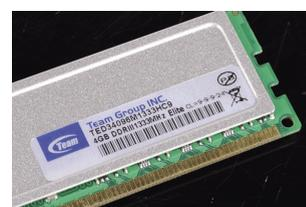
尽管覆盖了散热片,但从缝隙仍然能看到电容数量并不算多,各种走线不算清晰,总体做工一般。
