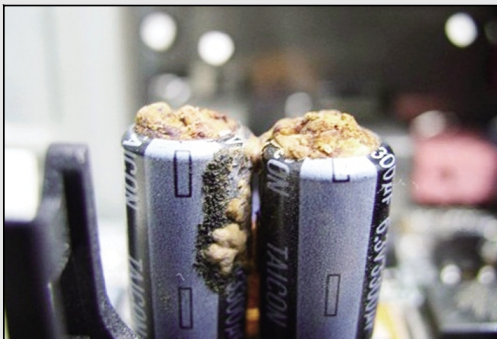
● 电容爆浆,内部电解液爆出
