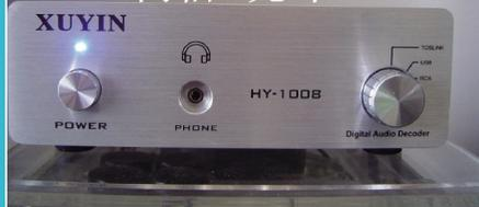
无需技术,可以换不同的运放,出来的都是不同的声音,可玩性很高,可以自由换你喜欢的声音风格,还可以更换 627 单转双运放(很多 DAC 电路都无法支持 627 运放的)。电源使用的是内置 + -15V 双电源供电(电源滤波使用的是日本原装黑金刚 4700UF 大容量电容),保证了音质的输出纯净。
