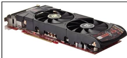
●在很大程度上,双风扇的设计保证了显卡在满负载时的散热需求
