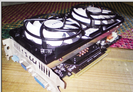
● 散热器安装完成
