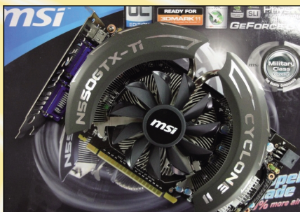
● 微星 N550GTX-Ti 采用了开放式散热器
