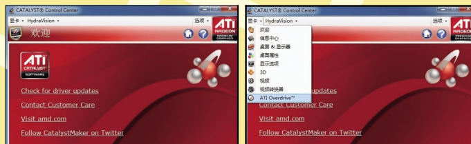
● 第一步打开标准的 CCC 驱动控制面板 ● 第二步选择 ATI OverDrive 选项
