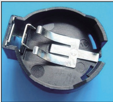
●使用时间较长的 主板, 电池座 漏电的几率较大
