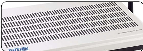
●散热孔多有利于快速散热
