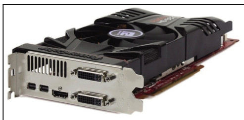
●迪兰恒进 HD6870 酷能 +1G 具备 5 个视频输出接口
