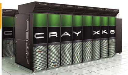
Cray 公司正式发布了新一代超级计算机系统“XK6”,由 AMD Bulldozer 推土机架构处理器 Opteron 6200 系列、NVIDIA Fermi 费米架构计算卡 Tesla 20 系列强强联手而成,峰值浮点性能最高可超过 50PFlops(5 亿亿次每秒)。而目前排名世界第一的中国天河一号 A 峰值性能也才不过 4.7PFlops,不到 XK6 的十分之一。
