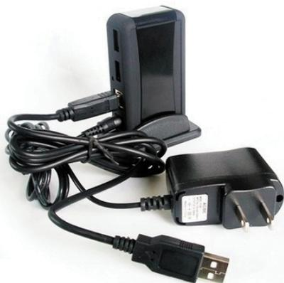
这个 HUB 采用了电源辅助供电,可以同时拖动 2 个移动硬盘或者 1 个移动硬盘,其它 6 个口同时
