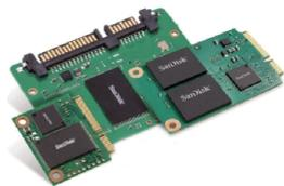
SanDisk 日前发布了一款固态硬盘——U100,该固态硬盘是之前 SanDisk P4 系列模块化 SSD 的升级产品,拥有三种规格:Half-slim SATA、mSATA 和 mSATA mini,都比 2.5 寸硬盘规格小得多,却仍拥有 SATA 6Gbps 数据接口,最高连续读取速度 450MB/s,连续写入 340MB/s,容量从 8GB 到 256GB 都有。
