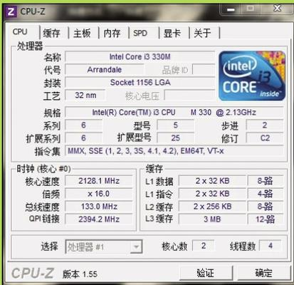
●在正常使用的情况下,CPU 频率在 1197.3MHz 到 2128.1MHz 直接不断波动。
