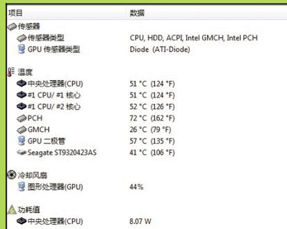
●在只运行几个小软件的情况下,CPU 平均温度在 51 度,GPU 平均温度为 57 度。
