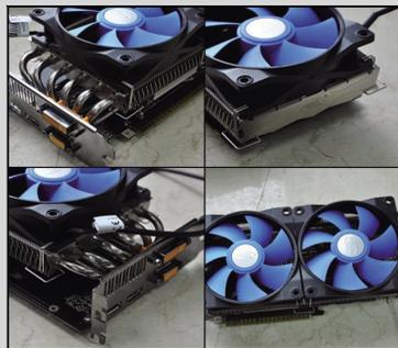
● 六热管散热器安装到显卡上
