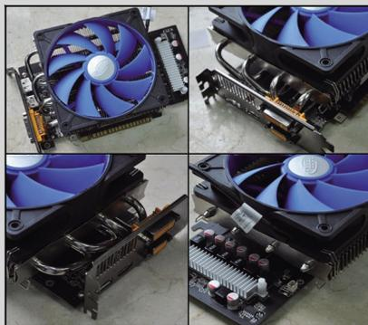
● 四热管散热器安装到显卡上
