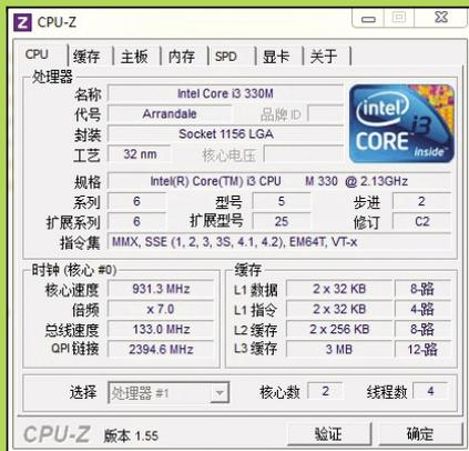
●在只运行几个小软件的情况下,CPU 频率在 1197.3MHz 和 931.2MHz 这两个频率直接不断波动。
