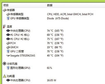
●在测试时,CPU 最高温度为 83 度。在测试过程中 CPU 温度在 69-74 之间波动,GPU 温度在 66-70 之间波动,硬盘温度变化不大。
