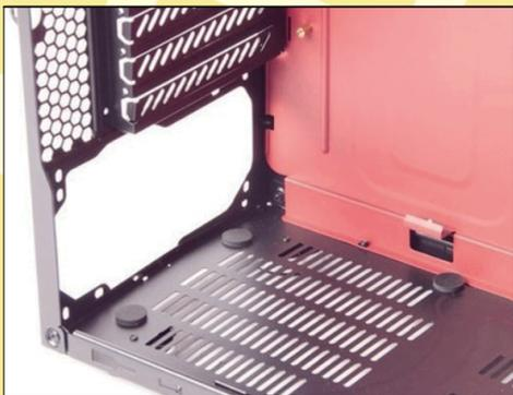
● 电源下置能使机箱内部降低 2~3 度
