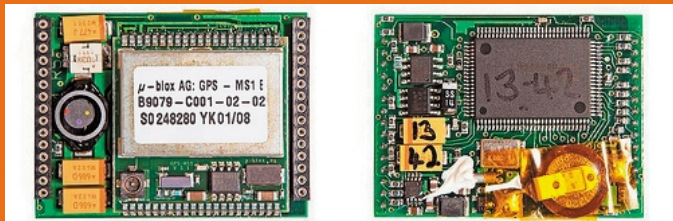
▲GPS 信号处理模块,是 μ-blox 公司的 GPS-MS1,相当老的型号,发布日期是 1999 年 6 月 29 日!
