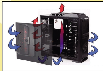
●顶部散热器的效果优于背部散热器
