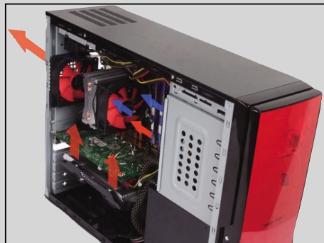
● 安装机箱散热器的时候别把它给装反了
