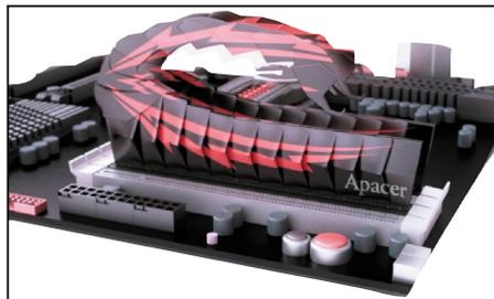
末日赤蝎采用了散热片顶部鳍片的设计思路,以两块散热片组合而成,表面的褶皱也有效增加了散热表面积,提升了其整体散热能力。这款设计并没有加入高端的热管辅助,这也其整体成本得以有效控制。相信投入生产后,我们将在中高端宇瞻内存上看到这款产品。
