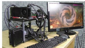
PNY 日前展示了一款特别的超频版 GeForce GTX 580 单芯旗舰卡,虽然使用了水冷散热,但除了伸出的两根水管外,该卡从外观上看和公版卡几乎一模一样。这款显卡名为 XLR8 GTX 580 Enthusiast Edition,使用的水冷散热器来自名家 Asetek 公司。散热器为全封闭式免维护设计,120mm 热排。公版频率 772/1544/4008MHz 下完成 FurMark 测试的温度为 45.8 摄氏度,同比公版散热器为 70.3 摄氏度,同时噪音比公版卡低 5 分贝。而在超频频率 995/1846/4400MHz 下,水冷散热器仍能保证该卡以 52 摄氏度低温运行,噪音不过 34.6 分贝。
