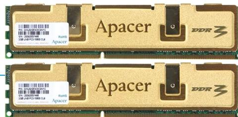
宇瞻黑豹的“黄金甲”散热片采用的是独特的双排扣设计,高强度的扣合力道可以确保内存芯片与散热片紧密结合,使内存芯片热量有效传到散热片上达到最佳的散热效果。并且在内存的散热片内部,采用弱黏性高传导系数的导热片,内存与散热片透过扣具紧密结合在一起。金手指采用镀金工艺,金层色泽纯正,具有极好的耐磨和抗氧化特性。
