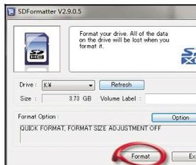
如果你的电脑上只插上了一个SD扩展卡,那么该软件可以直接识别出来;倘若你的电脑上同时插上了多个U盘、SD卡和移动硬盘的话,请务必先在“Drive”栏中选择正确的驱动器盘符以避免杯具发生。该软件的操作颇为“傻瓜”,在检查一遍无问题后直接单击“Format”按钮就行了。除了恢复安卓手机的SD卡外,用这款工具还可以检测一下你的U盘是否被扩容,赶快来试试吧!
