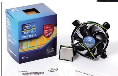
● 盒装散热器无法扛住 SNB 处理器超频
