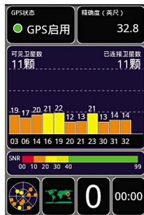
先观察左上角GPS状态,如果显示“禁用”,点击它启用GPS。但在屋里搜星并不容易,经笔者实测,在楼层较高的室内、离窗口五米左右的距离,大约15-20分钟就能搜到星,而且一般都在8-9颗以上。
