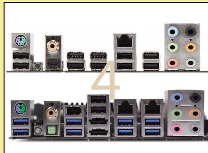
最后第四部分的背板 I/O 面板方面。高端 P67 主板具备了 8 组 USB3.0 接口和 4 组 USB2.0 接口。并且支持双千兆网卡和 IEEE1394。可以说接口相当丰富。而入门级 P67 主板上则只有 10 组 USB2.0 接口, 和一个千兆网卡接口。
