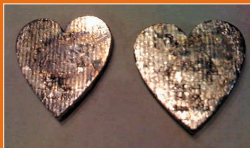
●表面五彩缤纷的那个是一层薄薄的氧化物
