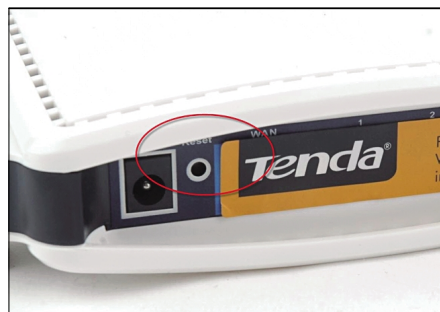
● 按住 reset 孔就可以重置路由器
