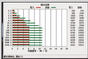
● 读卡器直接插到主板上的测试结果
