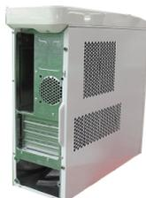
留了4个PCI挡板,扩展能力强大。并且尾部还特意设计了一个出风口,加装风扇后能增强机箱的散热能力。
