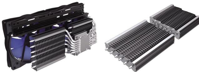
德国散热厂商 EKL 宣布了新款显卡散热器 Alpenflhn Peter,规模绝对不亚于当今顶级的 CPU 风冷散热器产品。该散热器采用了 6 根镀镍铜质热管,两组共 91 片铝制散热鳍片,整体长度几乎可以覆盖目前的顶级显卡。主动散热方面,该散热器号称全球首款使用双 140mm 风扇的显卡散热器产品,风扇模块外挂,通过机箱的 PCI 卡位固定,并通过一套轨道式系统加固。该散热器支持目前 AMD 和 NVIDIA 各主流显卡,而售价暂未公布。
