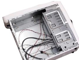
比较传统的布局,安装硬盘和光驱的部位都可单独拆下,非常方便。电源采用下置设计,和主板不会产生冲突。
