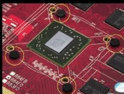
核心四角设有专用橡胶垫片, 有效保护圆形芯片, 防止散热器压坏核心。
