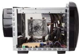
内部空间不大,但比较合理,电源外置后有足够的空间安装各种散热器和显卡,机箱侧板上也有大量散热孔。
