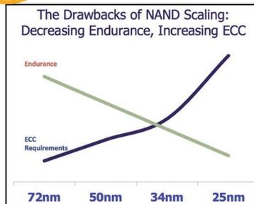
随着半导体制程的进步,NAND 闪存的可靠性会明显下降,需要付出更多的代价来满足 ECC 纠错需求,并预留更多存储单元来用于闪存老化、部分存储单元寿命用尽后的屏蔽、替代问题。比如,目前大量在固态硬盘中使用的 34nm MLC NAND 闪存的存储单元实际写入寿命在 5000 次左右,而 25nm 闪存则只有 3000 次。
