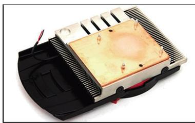
● 巨大的纯铜底座确保散热效果
