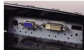
VGA、DVI、HDMI三种主流接口全都具备,能很好地兼容各种设备,此外还有一个音频输出接口。
