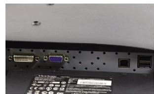
同时具备DVI和VGA接口,额外添加的USB接口,和主机连接后,用户在显示器上就可以使用USB设备。
