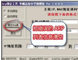
**Step02:** 选择如果自动绑定无效,请选择手动绑定,输入主机 IP 地址例如 192.168.1.1 再输入 MAC 地址,点击“ARP 绑定”即可。以后开机的时候会有一个黑框出现,这是调用 system32 目录下的 arpkba.bat 引起的,属于正常情况。
