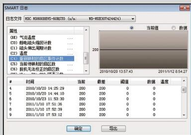
●重新映射的扇区事件计数没有任何变化
