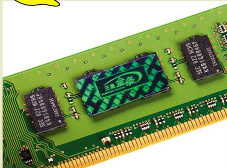
破 3200MHz,成为现今运行速度最快的内存。作为最新一代内存,三星 DDR4 内存将会使用虚拟开漏极技术,透过该技术可大幅度降低数据在读取、写入时候内存颗粒的漏电情况,与 DDR3 相比大约可降低一半的漏电,DDR4 将会更节能更高效。
