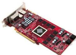
迪兰恒进 HD5850 恒金 1G 并没有因为低价而缩水,PCB 上无论是供电设计,还是各种用于滤波的电容,都设计得中规中矩。
