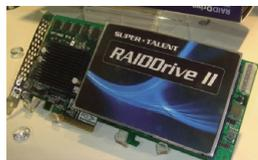
Super Talent 的顶级产品名为 RAIDrive II,基于 SandForce 方案并联而成,最多可使用 8 颗 SandForce 控制器,容量达到 2TB。其连续读取速度可达惊人的每秒 2.4GB,写入 2.2GB/s,随机读写达到 23 万 IOPS。该卡使用 PCI-E x8 接口,并且需要 4pin 辅助供电。
