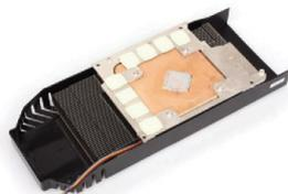
尽管有大体积的散热片,但没有采用热管设计,因此热量的传递速度会较慢,如果遇到夏天的极端气温,不知道显卡是否能撑住。
