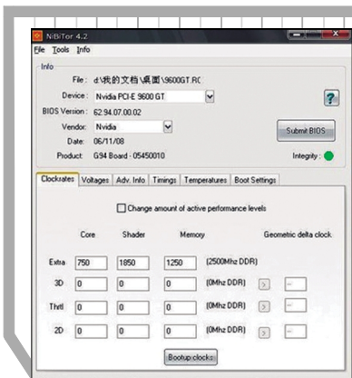
●用 nibitor 可查看显卡 BIOS 内的频率和电压设置
