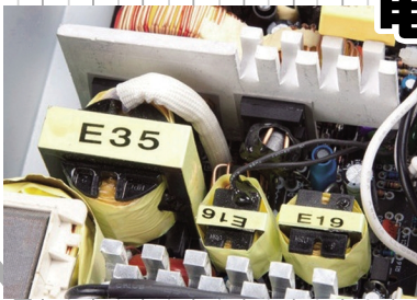
● 电源变压器可能发出“嗡嗡”声
