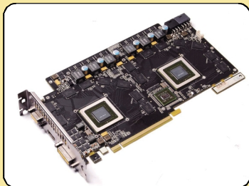
索泰 GTS250X2,由两个 GTS250 核心组成
