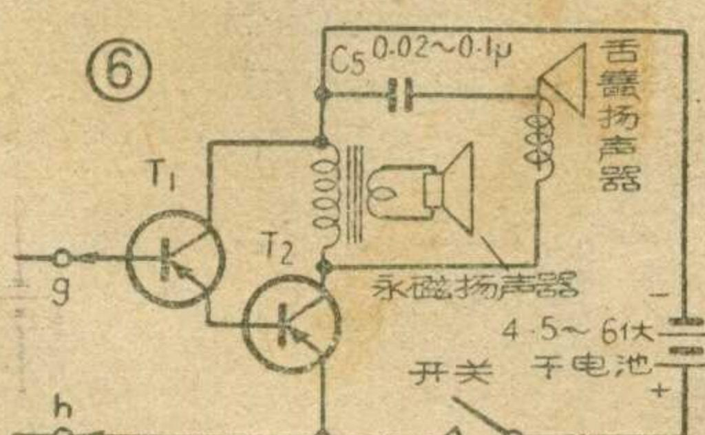
扬声器还可以保留，接成并联，使两只扬声器同时放声，高、低音都很丰富。为了避免舌簧扬声器通过直流容易失磁，并配合阻抗起见，可以串接一只 0.02~0.1 微法的电容器  $C_5$ 。
