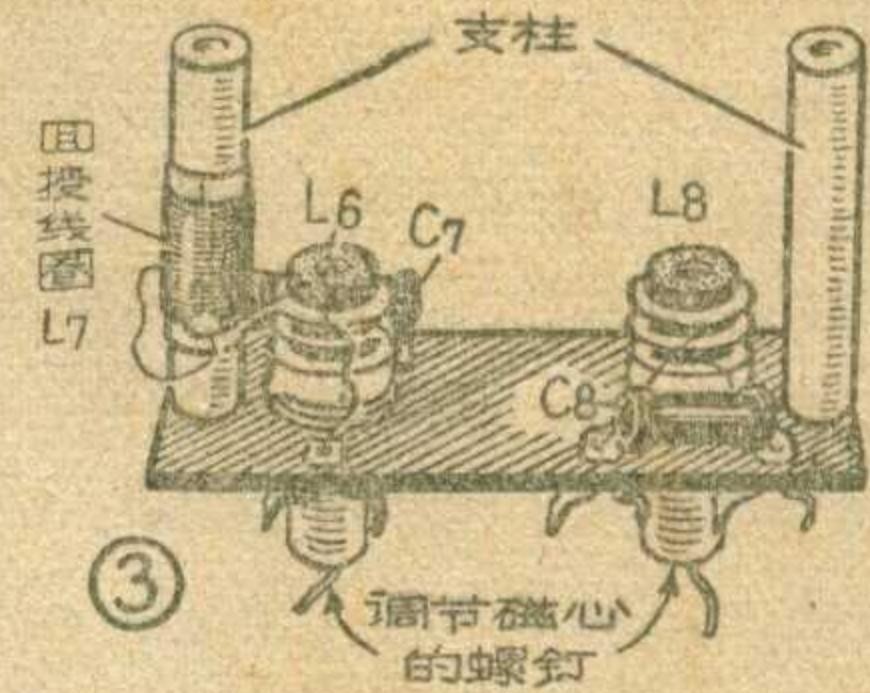
后旋动双联可变电容器，任意接收一个广播节目（最好是接近高频端的）。然后向电台中心频率两边反复缓旋双联可变电容器，听听有没有啸叫声。如有啸声，应将回授线圈朝底板方向微微移动一些，再仔细听听，如此反复试验直到没有啸叫声为止。最后用磁漆将回授线圈的位置封固。
