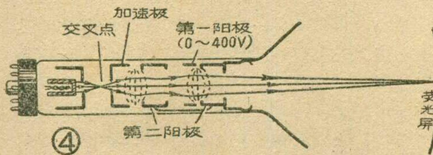
加速极形成；其等位面如虚线所示。由阴极上不同点和不同角度发射出来的电子通过这一透镜后在栅极前交叉成一点。过了这一点后电子重新散开。第二只透镜由加速极和第二阳极的左边一节形成；它起着辅助聚焦作用，把散开的电子在未进入第三只透镜前再作一定程度的会聚。第三透镜由第一阳极和第二阳极的右边一节形成
