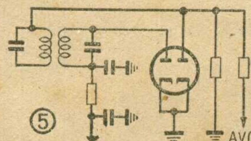
中频变压器初次级槽路的负载平衡，不致产生谐振曲线不平衡而失真的现象。
