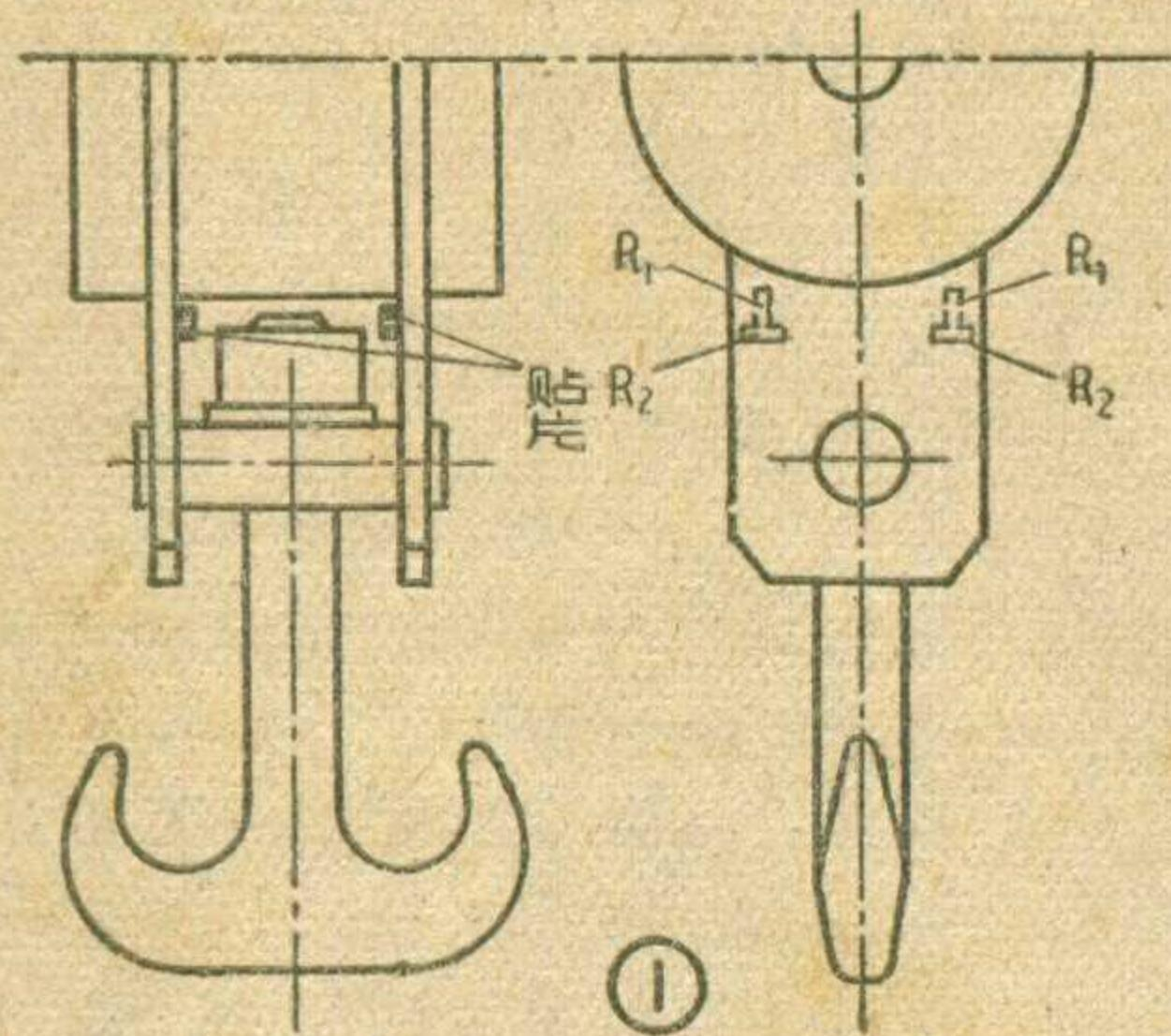
利用别的设备上的某些零件来代替。测量对象不同，其形状和安放位置也有差别。图1是把吊钩的侧板当作承重元件。在与重力平行和垂直的方向上各粘贴一个应变电阻( $R_1$ 和 $R_2$ )，它们和
