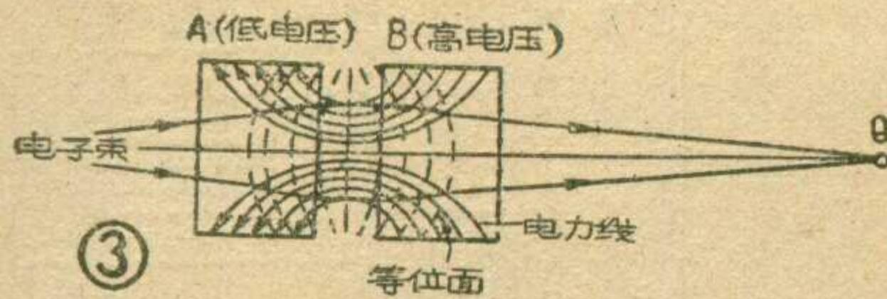
“A”上加低电压，“B”上加高电压，则电力线和等位面如图中实线和虚线所示。当电子束由A方射向B方时，由于电子有力图以垂直方向穿过等位面的趋势，结果那些和轴成一角度向前散射出去的电子在透镜的左侧时将受到一个使它趋向轴线的力量，使它聚焦；而在右侧时则受到一个使它离开轴线的力量使它发散。但因为在右侧时电子速度较快，故聚焦作用仍将大于发散的作用，结果使电子束在前面的Q点聚成一点，这便是焦点。
