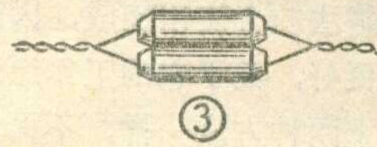
薄膜电容器的稳定性很高，密封结构的产品由制成之日起在技术条件允许的工作情况下，一年内的电容量变化不超过±0.3%；非密封的结构不超过±0.5%；要求较高的电容器不超过±0.1%。在电容器芯子内加适当的衬垫，或用浸锡铜箔代替打扁浸锡铜线（如图4），以避免打扁引线的楞角使薄膜处于应力较高的不稳定状态，采取这些措施，可提高稳定性。
