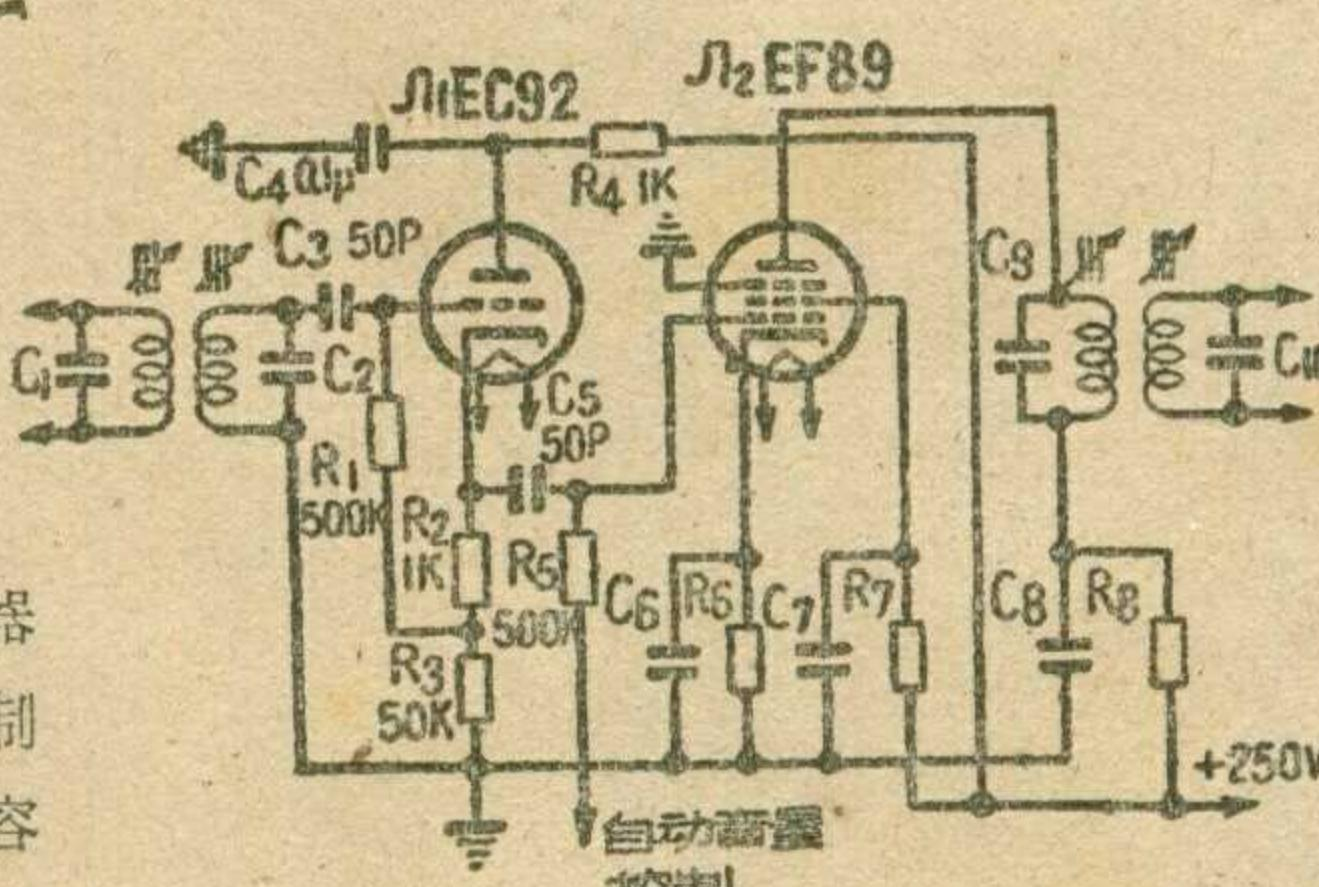
图 1 所示的中放級線路，虽然比較复杂，但却能有效地減弱自激傾向。它由五极管放大器和三极管阴极輸出器組合而成。阴极輸出器沒有放大作用，但将輸入回路和輸出回路分隔开来，可以避免这两回路的寄生耦合。这样就可采用品質因数很高的諧振回路了。
