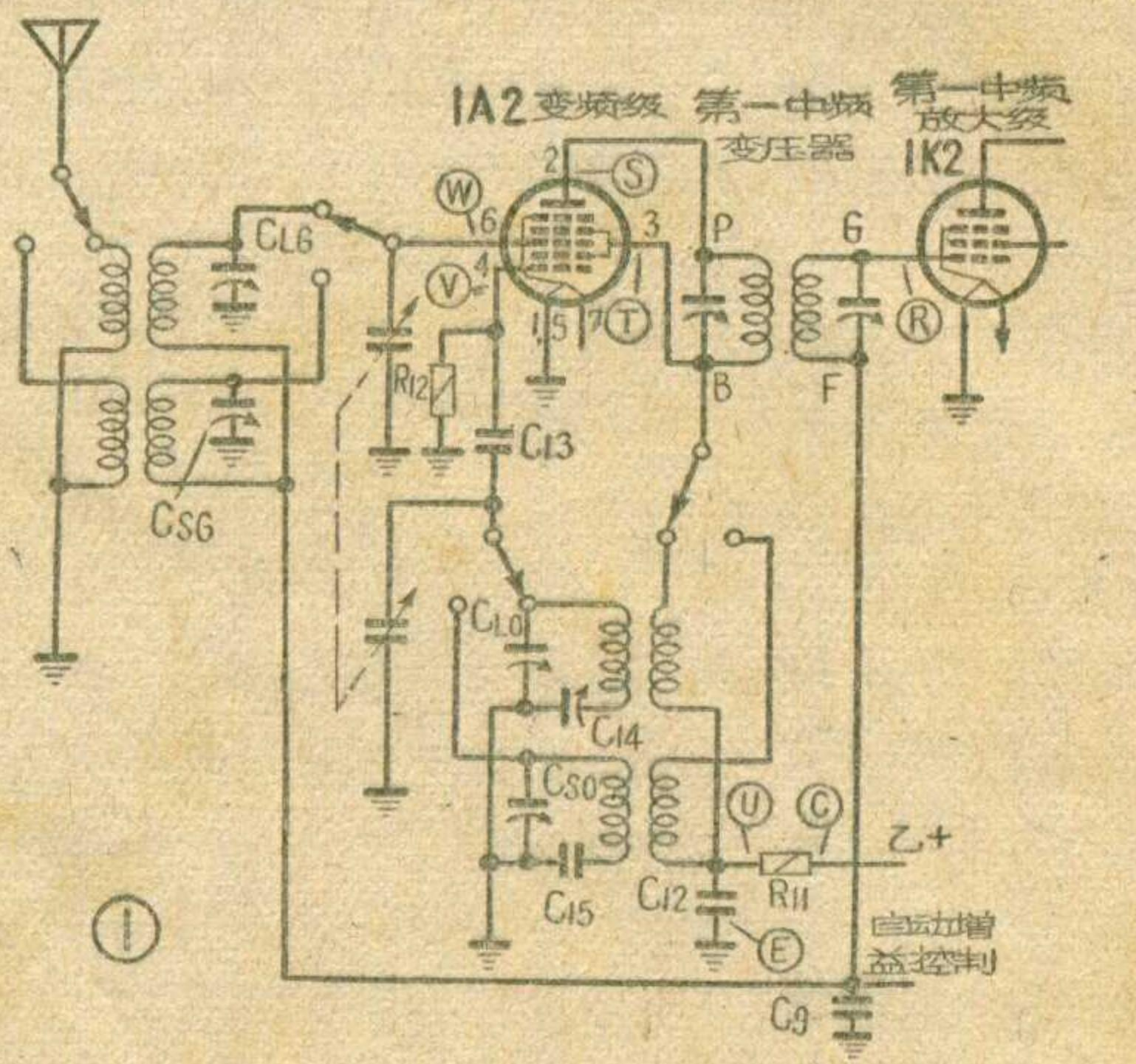
第二栅极旁路电容，使第二栅极所输出的高频电流能够顺利通过，构成稳定的振荡电路。这个电容器承受的电压很低，一般击穿的情况是不会有的。但可能由于脱焊开路，使振荡停止。可另用0.01微法电容器与它并联试一试。在渔区的直流机中，它也可能受潮变质漏电，使振荡停止。C<sub>12</sub>如有漏电的情况，测量 E—U 点电压将低落。检查时可将电容器一端浸开，用欧姆表检验它的绝缘电阻是否低落。
