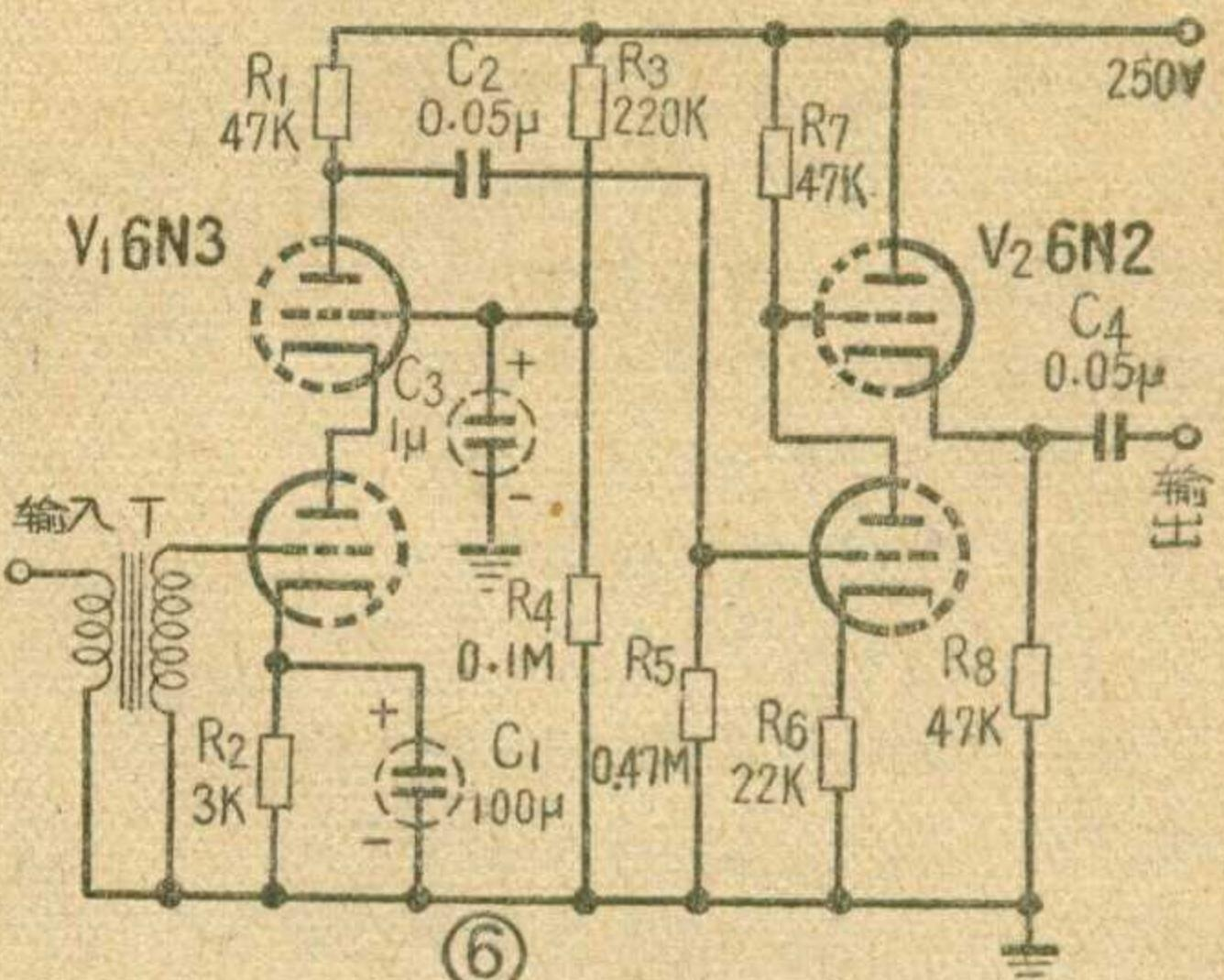
$\mu_1 (1 + \mu_2)$  相应于这个电子管的  $\mu$ , 而  $R_{i1} (1 + \mu_2) + R_{i2}$  相应于这个电子管的  $R_i$ 。因此, 可以把两个串接电子管看成是一个等效电子管, 这个等效电子管的放大因数  $\mu_d = \mu_1 (1 + \mu_2)$ , 而内阻  $R_{id} = R_{i1} (1 + \mu_2) + R_{i2}$ 。
