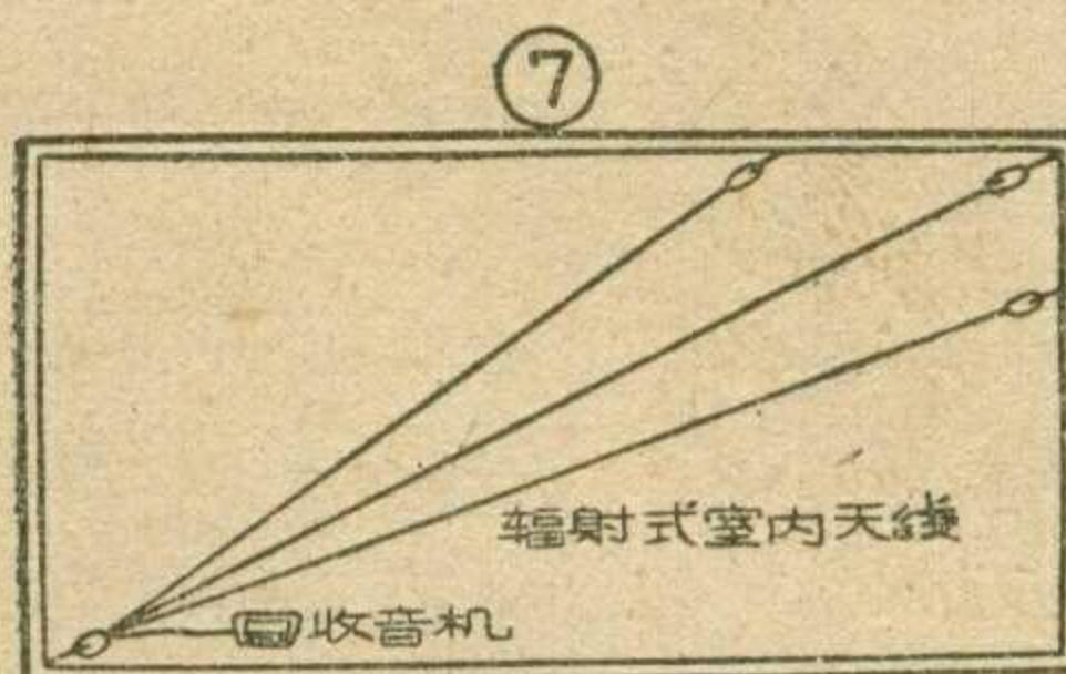
为了在雷雨时仍照常收音，可以改用屋内辐射式天线。在屋頂距天花板 50 厘米左右，用多股铜绞线绑在陶瓷或玻璃绝缘子上，拉三根辐射式天线，如图 7。经过实验，在二楼上拉成这种辐射式天线效果很好。如在楼下，可以多拉几根。如在农村或郊区，架设室外天线也可以得到良好的效果。地线可借用自来水管，在自来水龙头上焊一根铜线，接到收音机地线端子就行。如果有条件的话，能埋下好地线效果也一样。
