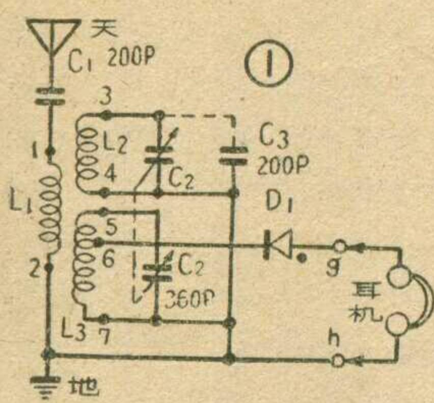
电台的无线电波由天綫收下来以后，就变成了许多高频率的信号电流，它们通过电容器  $C_1$  流过綫圈  $L_1$ ，到地下去，完成回路。通过电磁感应的道理，这些高頻信号又傳到綫圈  $L_2$  里，再傳到  $L_3$  里。电容器  $C_2-C_2'$  是一个双連可变电容器。 $L_2$  和  $C_2$  組成了一个回路，它能选出我們需要的电台信号。同样，在  $L_3$  和  $C_2'$  組成的回路里再作一次选择。这样就把一切不需要的电台信号和杂音干扰都去掉，只剩下我們需要的电台信号。这就好比我們用篩子篩去灰土杂物，剩下純淨的豆子一样。經過这两次选择，混台現象基本上消除，用技术术语說，就是收音机的选择性提高了。然后把选出来的高頻电流，再用檢波元件  $D_1$ （矿石或晶体二极管）檢波，变成低頻电流，送进耳机，就能发出广播声。
