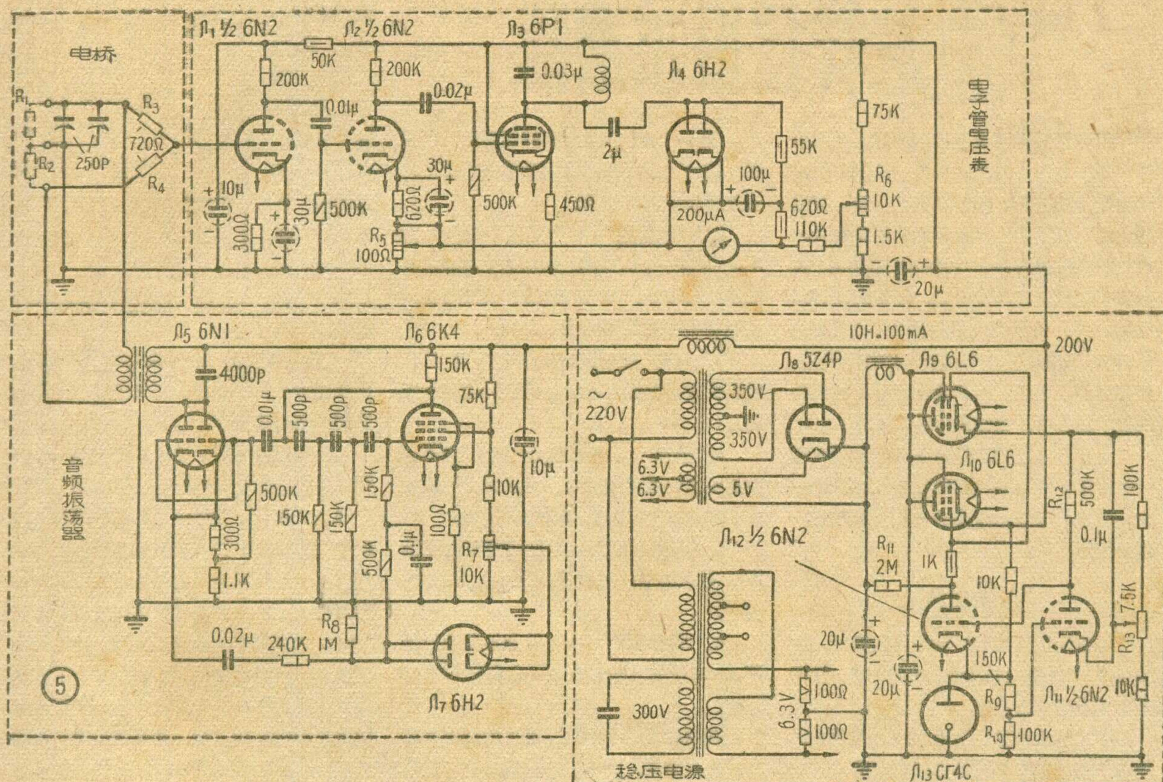
應該适中，这样既可以保证电子管电压表有足够的放大系数同时也能减小測量导線的分布电容对电桥平衡的影响。这里是按600赫設計的，試驗結果表明，在这个頻率下，电桥导線为60米时，导線位置的变动对仪器沒有影响。
