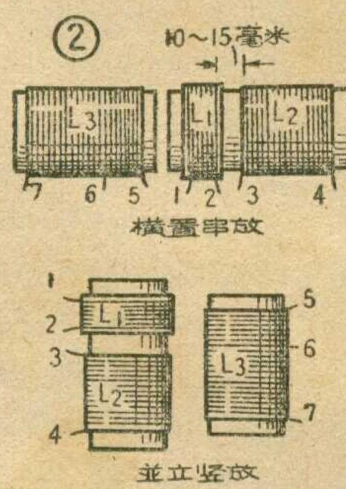
把綫圈做成脫胎式，可以利用裝一斤奶粉的玻璃瓶或洋铁罐，四周豎立八条或六条 5~10 毫米寬的馬糞紙条（最好
