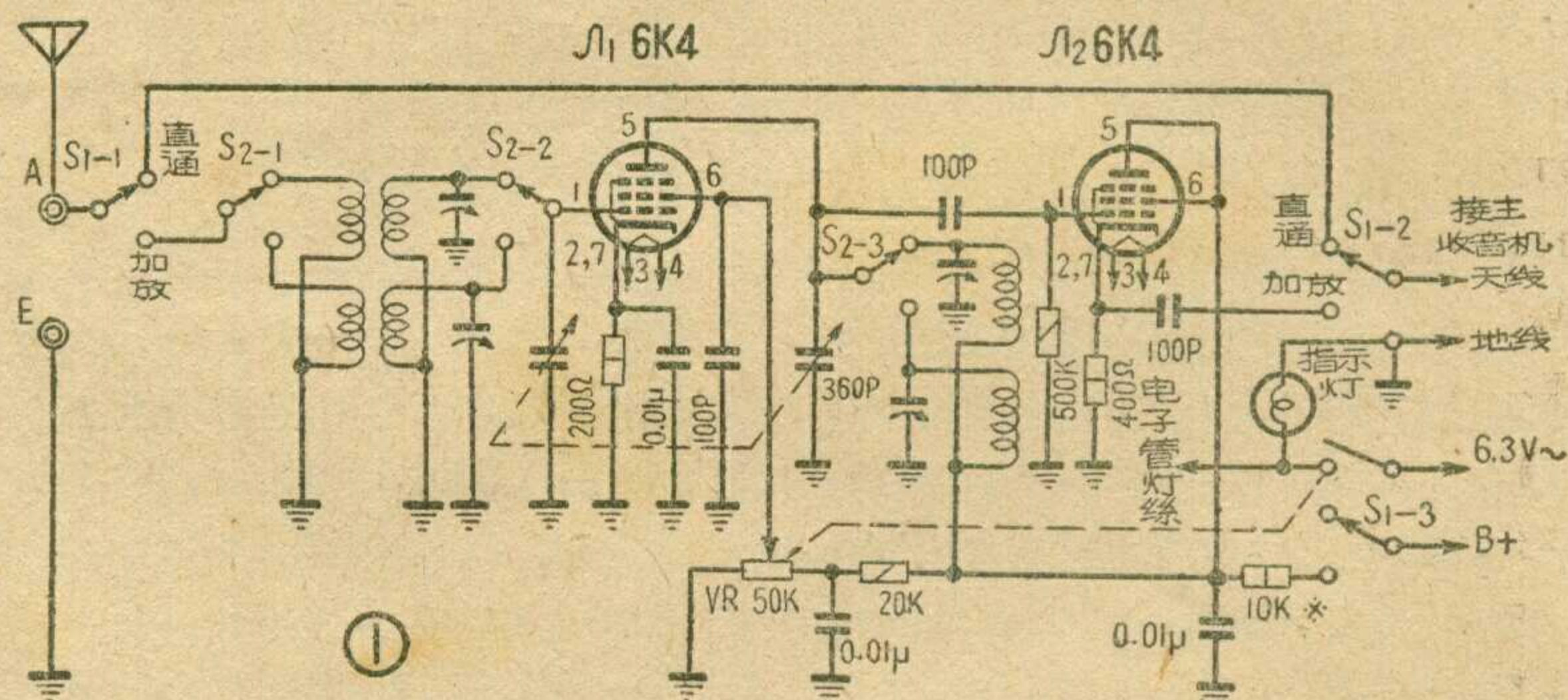
调谐回路分成多波段的，使每个波段的复盖频段不过大。电源完全取自主收音机，用多头插销相联接。经实验在一般五灯机上接用，电源过载问题不大。
