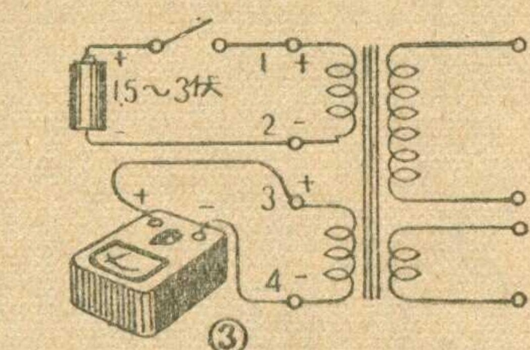
如果向正偏，表示接电池正的那端与万能表正极那端的線头为同极性。如果向負偏，则为反极性。
