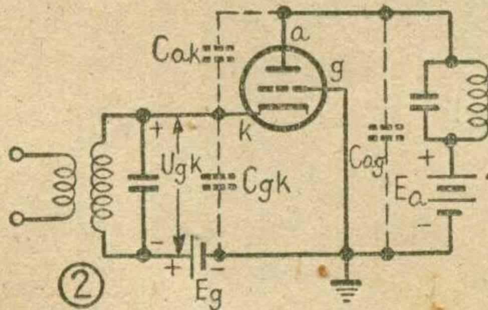
在接收微弱信号的灵敏接收放大设备中，第一个放大級本身产生的噪声必須很低。因为这时信号还没有被放大，非常微弱，噪声太大，就会妨碍正常接收信号，甚至把信号淹没。因此，在輸入級使用五極管是非常不利的，最好还是使用三极管。
