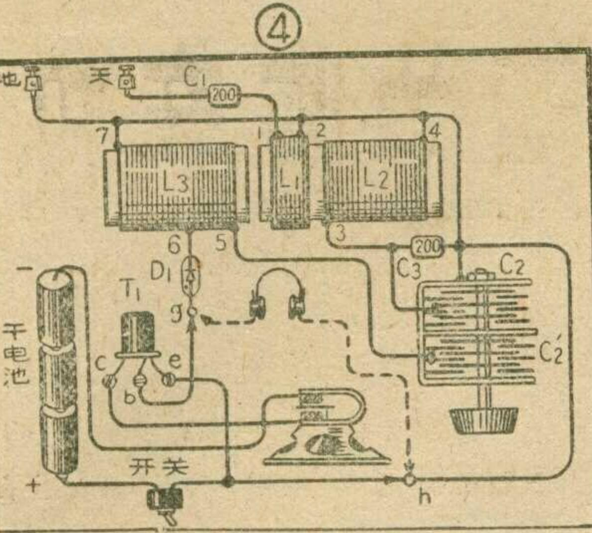
500 欧的也可以。如果要更响一些，可以将 1000 欧的舌簧扬声器线圈拆开，拆去大約一半线圈（稍多些些无大影响），再在剩下的线圈的一半处抽出一个头。这样相当于把剩下的线圈又拆成两个线圈，并联以后，电阻就成为 250 欧。还可以从这两个线圈引出四个端子，既可接成并联，又可串联，以适应不同阻抗的需要，使放声最响。如果是 500 欧的扬声器，也同样可以拆成 125 欧的并联线圈。
