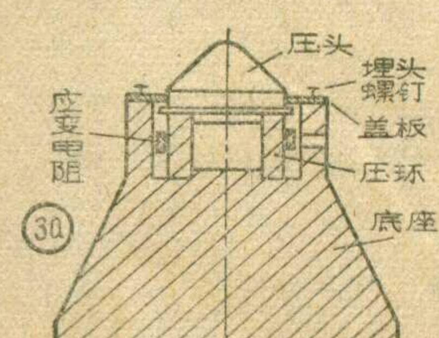
的另外两个电阻( $R_3$ 和 $R_4$ )组成一个测量电桥(见图2)。吊钩上没有重物时电桥是平衡的，没有信号输出；当吊钩吊起重物时，侧板由于受到拉力而变长，因而使顺着受力方向粘贴的应变电阻 $R_1$ 也变长，其电阻值增大(应变电阻 $R_2$ 变宽的影响可忽略)，这就破坏了电桥的平衡，电桥有信号电压输出。这一电压的大小与吊钩所承受的重量大小成正比，因此根据输出信号电压的大小，就可以指示出物体的重量。
