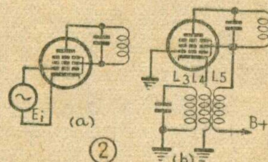
我们知道，将电子管阴极接地从栅极输入信号电压，与栅极接地从阴极输入信号的作用是相仿的。这种振荡器就是采用后者的形式。由于本地振荡频率比输入信号频率高一个中频(465 千赫)，输入回路对本振频率来说阻抗很低，因此可以近似地认为栅极是接地的。为了避免振荡线圈在阴极之间对输入信号产生过多的负回授作用，因此将阴极不接在调谐线圈  $L_3$  上，而是单接了一个低阻抗的耦合圈  $L_4$ 。因此通俗的说这种变频器是将本振电压与输入信号电压串联地馈送到变频管的栅阴极之间进行变频的。经过实验证明，这种变频器有着变频增益高而又节省零件的特点。
