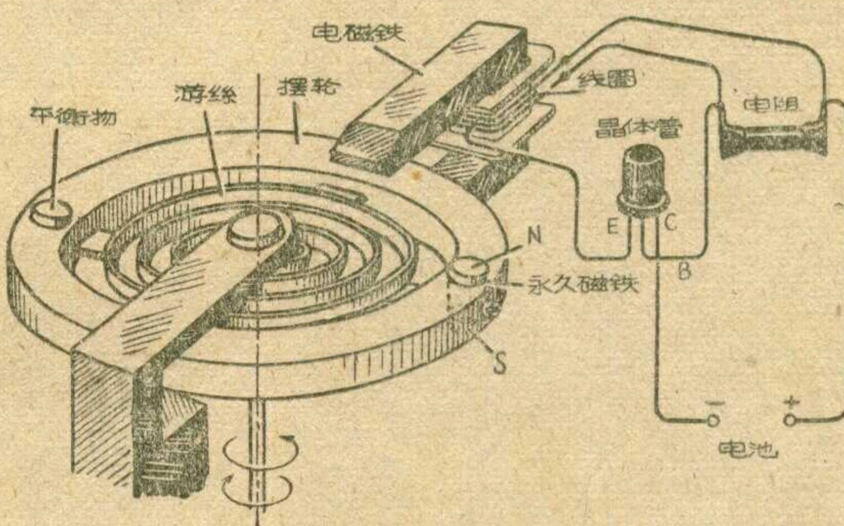
当摆轮转到一定角度后，依靠游丝的力量又会向回返转。当小永久磁铁又返至电磁铁中间时，就又会发生和前述相同的推斥过程，使摆继续摆动。如此“周而复始”，结果摆轮就连续摆动，再由一系列的齿轮带动分针、时针等指示时间。
