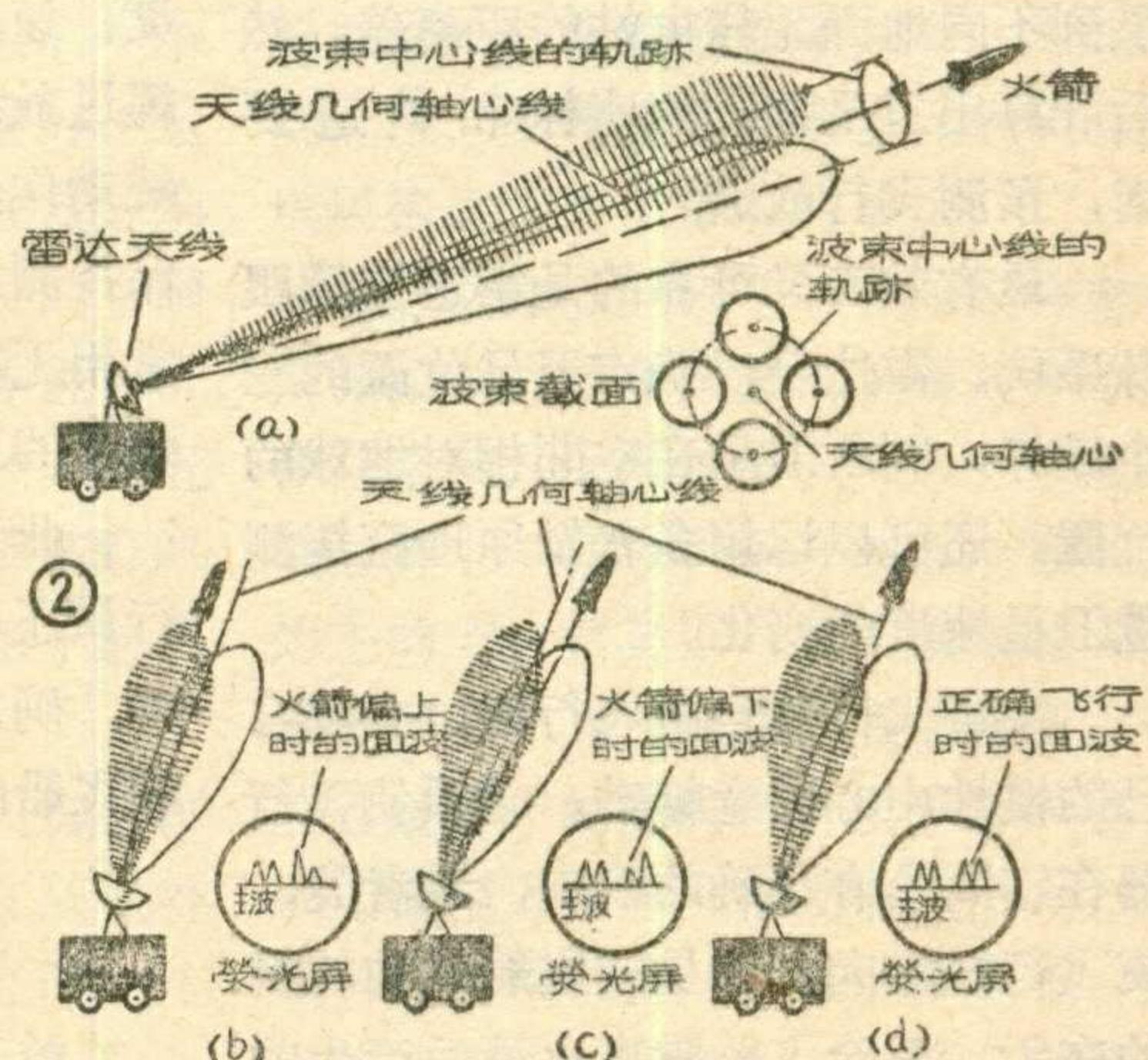
当火箭正好沿预定轨道飞行时，雷达荧光屏上才显示出等强度的回波信号（如图2d）。根据信号差值，向火箭发出消除误差的控制指令，可使它沿预定轨道飞行。
