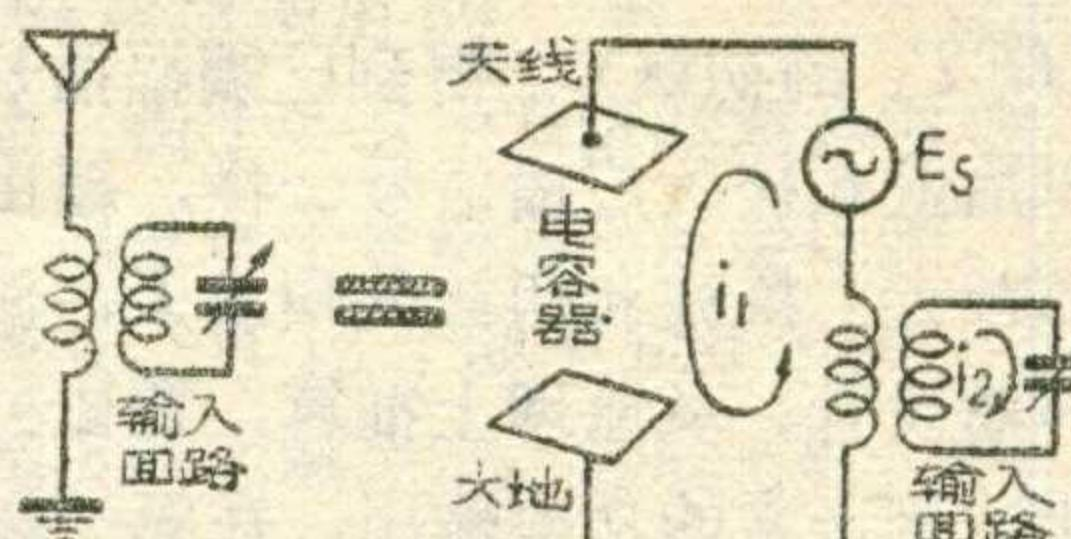
的收音机，只要在天綫綫圈的另一端接有一个导体，与天綫形成一个电容，收音机就能工作。例如我們常用的电子管收音机都有一个面积較大的底盘，这个底盘就和天綫形成一个电容，起了“地綫”的作用。虽然这个电容不太大，因而天綫回路中流过的信号电流較小，但是由于現代收
