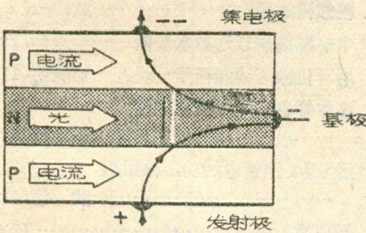
内工作。通常的高頻晶体管，它的基极必须做得极薄，以缩短电荷通过基极所需的时间，因此制造比较困难。很明显，光学晶体管便没有这个缺点。
