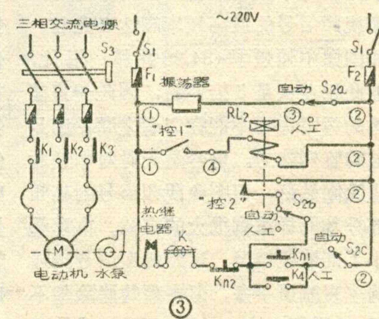
相等，就可得出上述的工作状态。否则，应再检查线路是否接错，零件是否有毛病。如果毫安表读数的变化范围与上述情况相同而继电器  $RL_1$  不动作，这说明继电器  $RL_1$  有故障，应检查修理。
