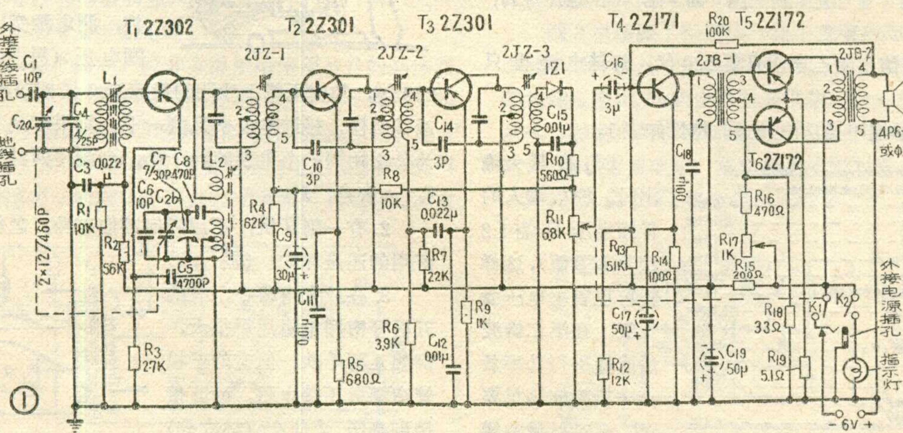
2. 振蕩線圈  $L_2$  用  $4 \times 0.08$  線包綫在 10 毫米線圈管上按蜂房式繞法順時針方向繞 66 圈，在起始第 8 圈上抽頭。再用 0.19 線包綫在距離主振蕩線圈 4 毫米處按蜂房式繞法順時針方向
