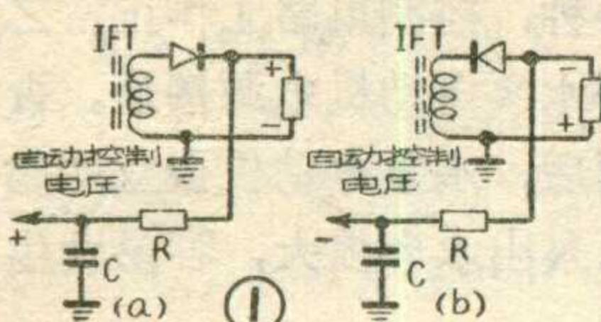
从图中可以看出，控制电压的极性是由检波二极管的接法来决定的，因此二极管的极性不能接错，否则就会起到相反的作用。
