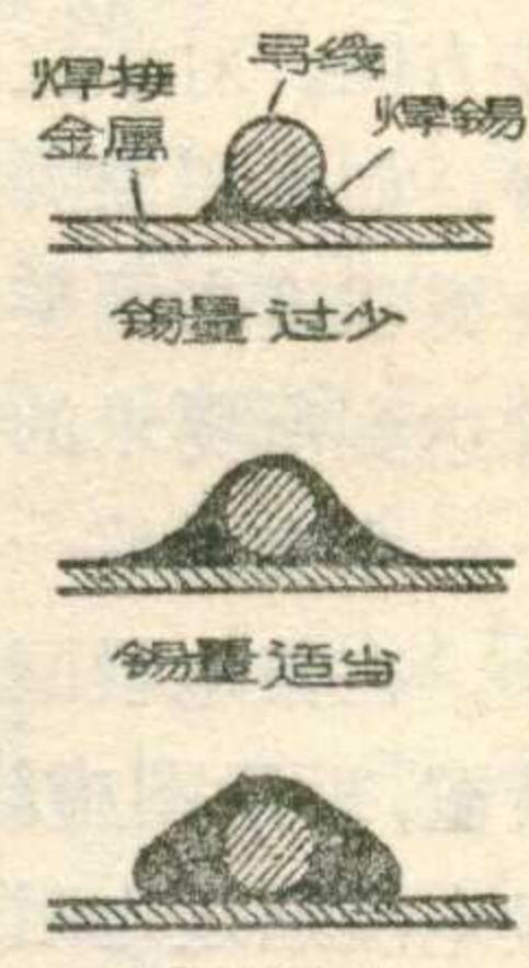
铁接触的部分到达熔点时也将熔化成为液态。这时由于溫度高，錫的分子运动速度加快，有些分子就像子彈一样冲击到烙铁的錫上，并被錫面包围起来，于是烙铁就蘸取到一定数量的錫。与此相同，烙铁将錫焊到金屬上，也是先对焊接部分加热，經過一定時間，到焊件上溫度高于錫的熔点时，由于焊药的帮助，烙铁上的錫分子也像子彈一样冲击金屬面，并靠它們間的分子引力而吸附到金屬面上。烙铁撤开后，焊上的錫即冷却結晶成为固体。
