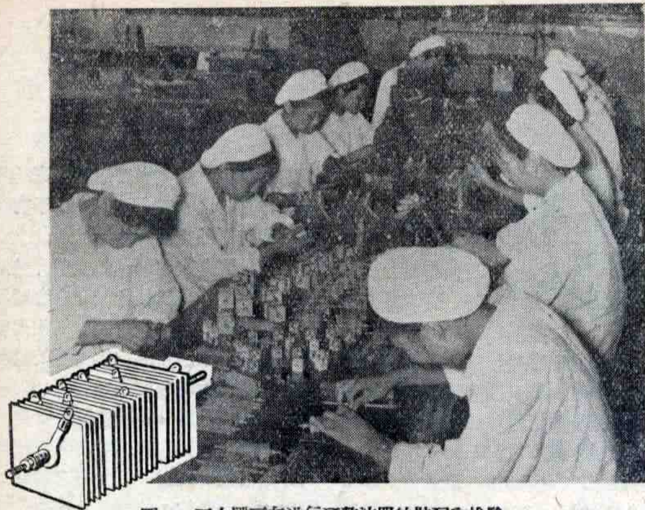
圖 2 工人們正在進行硒整流器的裝配和檢驗
