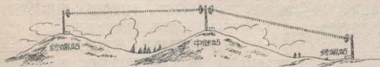
圖4 用RVG903D建立長途接力通信的示意圖
