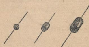
圖4 干式鉛極电解質电容器
