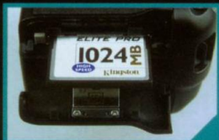
5D在存储卡插槽方面，只提供有CF插槽
