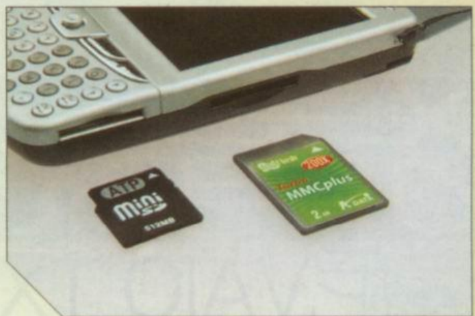
上:hw6515 的键盘间距较宽，在频繁输入时不容易误按 下:hw6515 同时支持 miniSD 和 SD/MMC 双存储卡
