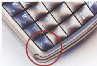
标准键盘的背光并不随翻盖的打开而亮起，毕竟要照亮面积颇大的键盘区域需要大量电能的支持，所以标准键盘的背光由专门的开关键来控制，待机状态时按一下亮起屏幕，连按两下亮起键盘背光，就像汽车换挡一般好玩
