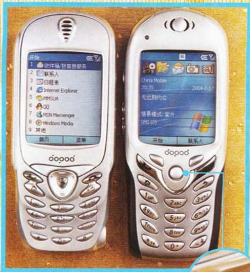
dopod 535 (右) 整机造型较 dopod 515 (左) 更为圆滑幽雅, 讲究时尚韵味又不失沉稳风格; 键盘区面积的增加避免了出现头重脚轻的情况; dopod 535 采用的五向摇杆设计使玩游戏时操作更灵活自如
