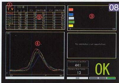
我们都知道,CCD就相当于人眼中的视网膜,如果成像落在CCD前后,都会引起解像力不良,通常我们看上去就像是图像模糊,我们也会说是对焦不准。解像力不佳时,需要调整CCD与镜头的间距,这里介绍一下大致的调整方法。如图6所示,CCD上三颗固定螺丝分别对应CCD四个顶角中的1,3,4位置,当图8界面中的规格值表(即图中②所示部分)对应的某个通道出现红色数值时,就需要调整对应的某个顶角上的螺丝。比如CH-1通道红色数值为“+”,则说明图6中1号螺丝比较紧需要拧松,反之“-”时拧紧;如果是CH-0通道为红色“+”数值,因为它是CCD的中心通道,这就表明CCD整体都靠近镜头,需要把三颗螺丝都拧松,最后调整完成需要固定CCD与镜头位置,防止拍摄时CCD晃动。总之,调整的工作是非常繁琐的,大多数校调工作都要交给仪器来完成,因此提高制造工艺水平,保证有足够的良品率对厂商而言是异常重要的。
