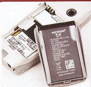
6820 采用了一种在诺基亚手机上很罕见的电池安装方式，后盖上卡着一块容量为 850mAh 的 BL-5C 锂电池。利用这块电池，手机的纯待机时间轻松迈过了 7 天大关，令人颇为满意
