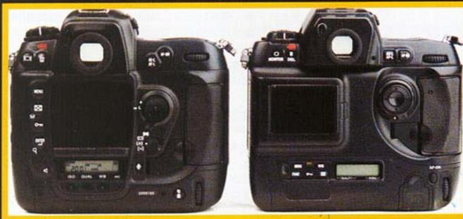
D2H (左) 按钮采用大尺寸设计, 操作方便。取景器稍偏左, 拍摄时鼻子不易碰到显示屏
