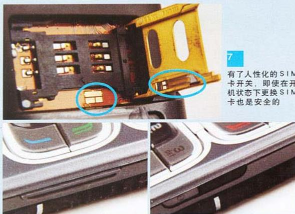
7 有了人性化的SIM卡开关,即使在开机状态下更换SIM卡也是安全的
