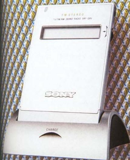
对于收音机这种需经常操作的产品来说，手感是相当关键的，索尼对于这一点的把握是相当到位的。SRF-G8V采用了镁合金的材质，坚固耐磨。轻薄的它厚度仅有8.3毫米，无论是放在上衣口袋还是别在腰间都不会造成负担。无论是位于机身右侧的Jog Dial滚轮还是机身顶部的其他控制键，都可以非常方便地使用单手操作。另外值得一提的是，SRF-G8V可通过外接充电板来延长播放时间，外接充电板上还设置了卷筒式耳机，可自由控制耳机线长度。机身内置的锂电池则可通过充电座进行充电。SRF-G8V的降噪功能可以有效的改善因杂讯所导致的收听不清的情况。它可记忆15个电台，并可设置30分钟、60分钟、90分钟、120分钟四个时段的自动关机。
