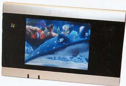
**PMC-100** 与PMP-100功能类似的PMC-100采用了不同的操作系统,由微软提供的Portable Media Player系统保证了PMC-100与其他微软系统良好的兼容性。
