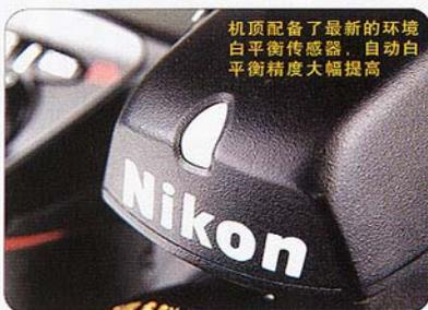
可以达到力挽狂澜的作用。白平衡设置方面,除了自动、白炽灯、荧光灯、直射日光、闪光灯、阴天、阴影等常见的一些预设白平衡之外,为得到更精确的调校,D2H还可以选择微调色温(2500K~10000K),用户校正模式达到5项之多,方便用户调用常用设置。结合D2H高速连拍的特点,使其可快捷、轻松地进行2~9张的白平衡包围拍摄。另外,新推出的尼康SB-800闪光灯,可通过附件使闪光的色温改变到与白炽灯或荧光灯的色温一致,解决了闪光与环境光无法协调的问题。通过在标准色温环境和白炽灯色温环境下拍摄的色彩标板来看,D2H的自动白平衡表现比D1X更加准确。
