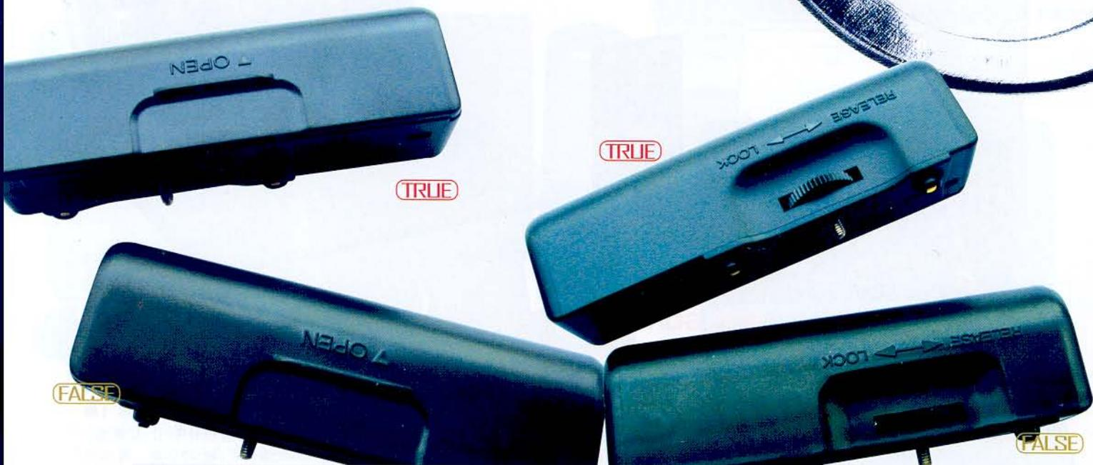
僅從造型和外部構造上看，真假電池盒幾乎一模一樣。但如果仔細觀察細節，會發現假電池盒的做工粗糙，边角還有比較明顯的毛刺。在正常光照環境下，可以看出假電池盒沒有原裝電池盒那種明顯的光澤度，而且塑料表面塗層不均勻，而原裝電池盒塗層均勻，很有質感。
