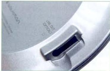
为了保持机身体积及重量上的优势，NE10将耳机插孔、LINE OUT和OPTICAL OUT接口融为一体，使得用户在使用CD给MD随身听录音时，不能通过线控液晶屏观察相应进程，增加了误操作的概率。
