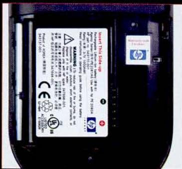
H4150 的电池可以拆卸，用户可以另外购买后备电池以保证更长的使用时间。为此，惠普特意为H4150的用户准备了1000mAh和1800mAh两种规格的电池零售（H4350的两种后备电池规格为1560mAh和3600mAh）
