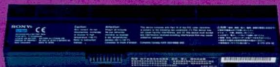
索尼V505MCP标配电池为一块11.1V、4400mAh (48.84Wh) 锂离子电池，测试结果为160分钟，考虑到其出色的性能表现，这样的电池测试成绩也是可以接受的。
