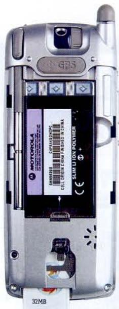
手机电池仓很简洁, 机身背部最下方是SD/MMC卡插槽, 手机原配32MB MMC卡
