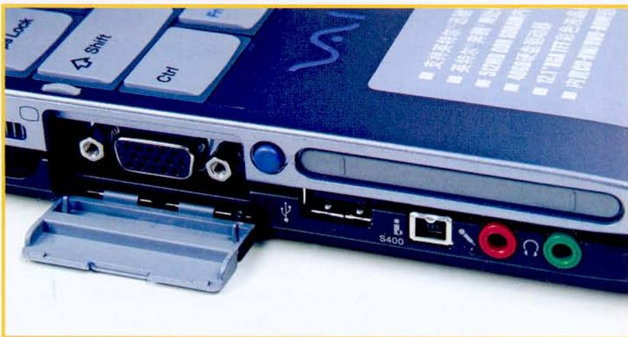
索尼V505MCP虽然拥有相对庞大的体积,但接口并没有因此而增多。机身上包括一个电源接口,二个USB2.0接口,一个4针IEEE1394接口,一个PCMCIA接口、网卡接口、MODEM接口、耳机插孔,麦克风插孔以及一个VGA输出接口。除此以外,记忆棒插槽也是肯定少不了的。
