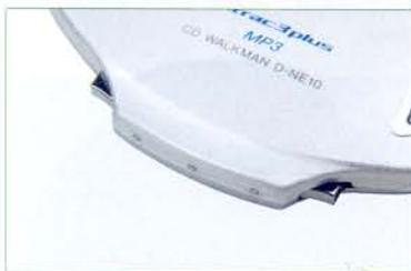
碟片仓的OPEN键则由传统的单键锁扣改为了双键组合操作，最大限度地防止了误操作。
