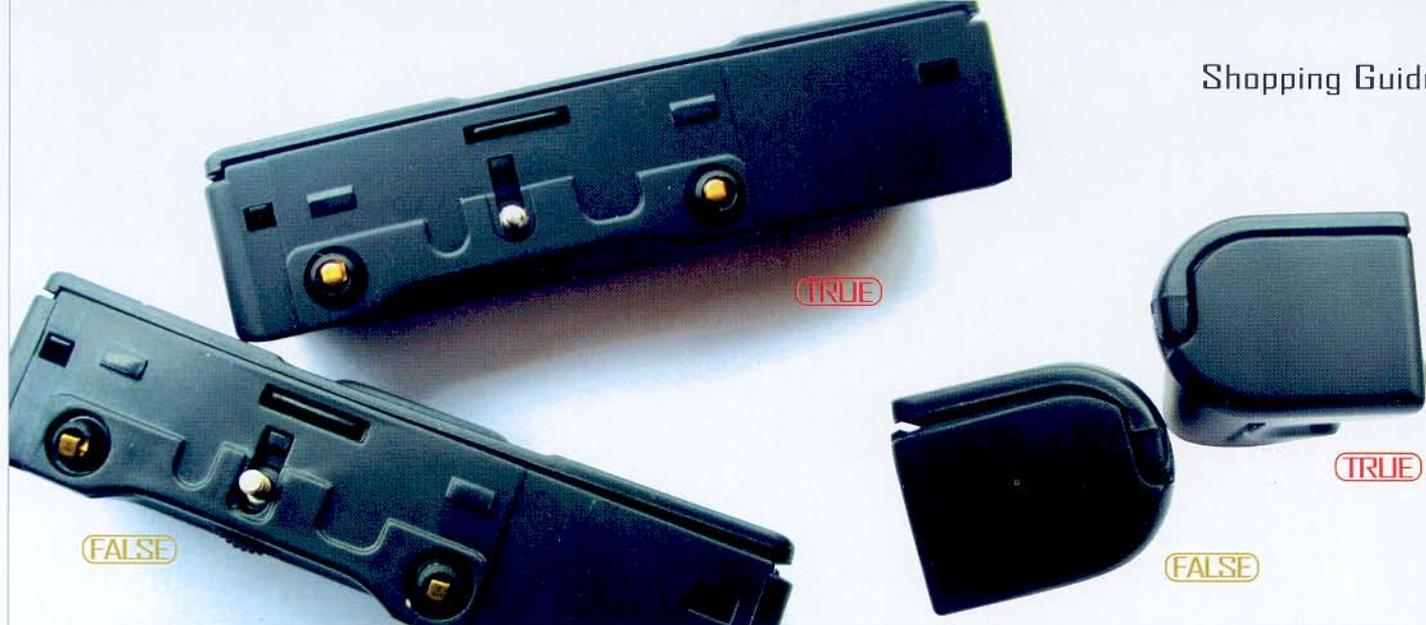
如上图所示，假电池盒上翻盖的接口处和盖子的颜色有差异，而原装电池盒的翻盖接口处和盖子颜色是同一颜色。而且原装电池盒的接合处细密，假电池盒的接合处松散，而且缝隙宽窄不一。
