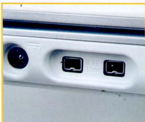
S180在接口拓展性能上令人满意,主机内置了2个IEEE1394接口和3个USB接口,使得经常连接数码产品的用户更加随心所欲,同时,S180也是本次评测中惟一具备AV输出接口的机型,可方便的接驳电视设备。
