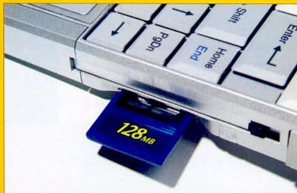
也许是因为体积过于玲珑,松下W2的接口就相对较少,包括两个USB2.0接口,一个耳机插孔,一个麦克风插孔,一个VGA输出接口,一个网卡接口以及一个PCMCIA接口。另外还具有一个SD卡插槽。
