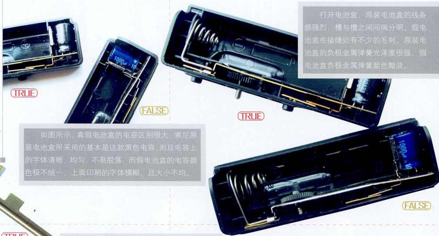
打开电池盒，原装电池盒的线条感强烈，槽与槽之间间隔分明。假电池盒在接缝处有不少的毛刺，原装电池盒的负极金属弹簧光泽度很强，假电池盒负极金属弹簧颜色黯淡。
