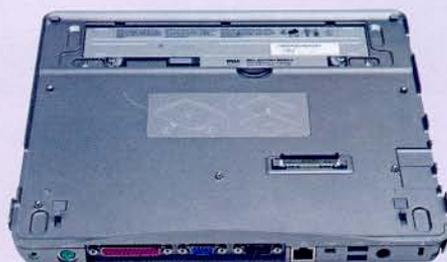
X300主机标配的是容量较小的14.8V、1900mAh (28.12Wh) 锂离子电池，因此在续航能力上处于劣势，不过用户可以通过更换8芯的4400mAh (56.24Wh) 后备电池或者将两块电池并联使用，电池使用时间将延长到8个小时以上。X300的电池还具有电池电量显示功能，即使在关机状态下，用户也可以了解电池的剩余电量。
