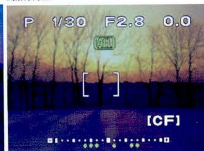
多点测光模式最多可测定8个部位，以平均值计算光圈和快门参数
