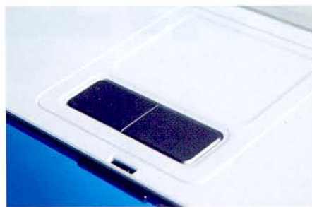
S5 触摸板的边缘过渡更为平滑，有效地避免了在触摸板边缘积累灰尘和污垢。
