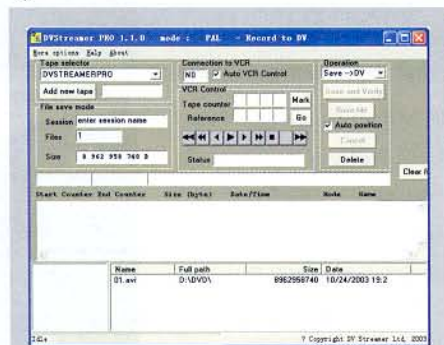
利用主窗口上方的VCR控制区，调整MiniDV带位置，留出足够的空间容纳文件（每分钟磁带空间可容纳约120MB左右的文件）。
