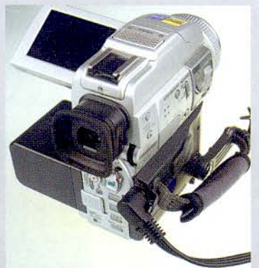
准备好数码摄像机配备的A/V线，将它的一头插入到数码摄像机的A/V接口上
