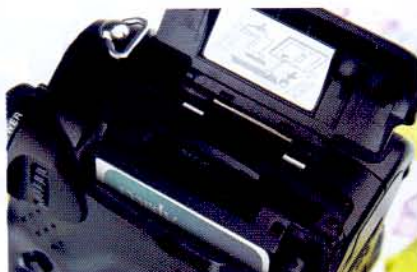
双插槽设计可在两个插槽之间复制数据，其一使用xD-Picture卡，另一插槽使用CF I / II型存储卡或IBM微硬盘
