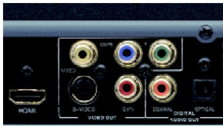
电视上的Ypbpr接口
