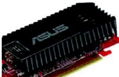
华硕 EAH3450/HTP/256M 的静音散热设计
