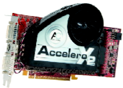
显卡过于夸张的散热器设计,对于机箱是个很大的考验
