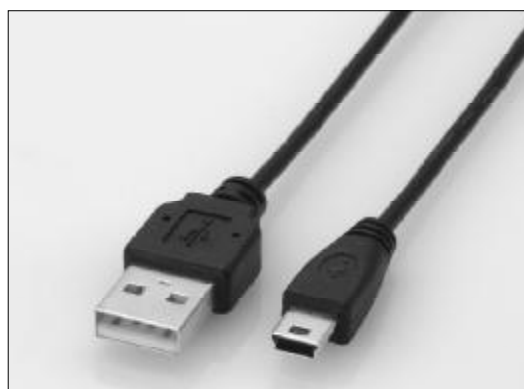
◆图 6-45 数码相机使用的USB数据线
