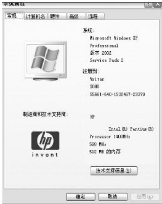
◆图6-23 移动CPU工作在较低频率下
