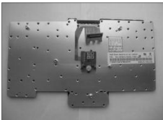
◆图 6-22 笔记本电脑键盘底部的散热板
