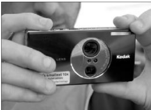
◆图 6-46 支持蓝牙技术的柯达 V610 数码相机
