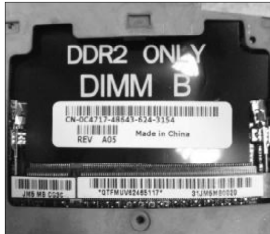
◆图 6-14 笔记本电脑内存插槽变形导致内存接触不良
