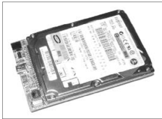
◆图 6-42 移动硬盘内部结构
