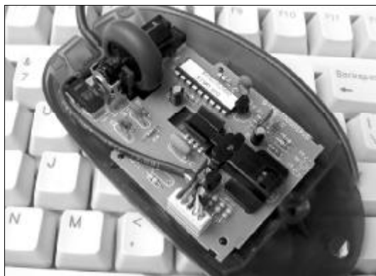
◆图 6-41 光电鼠标内部结构
