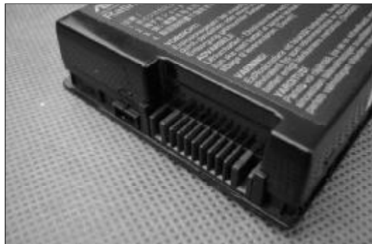
◆图 6-33 笔记本电脑电池输出触点部分特写
