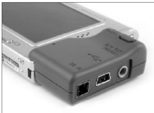
◆图 6-44 数码相机上的USB接口
