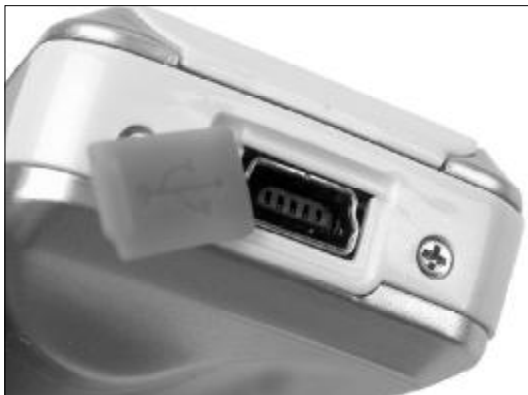
图 5-29 MP3 上的 USB 接口
