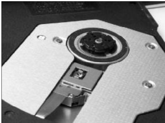
◆图 5-2 光驱激光头
