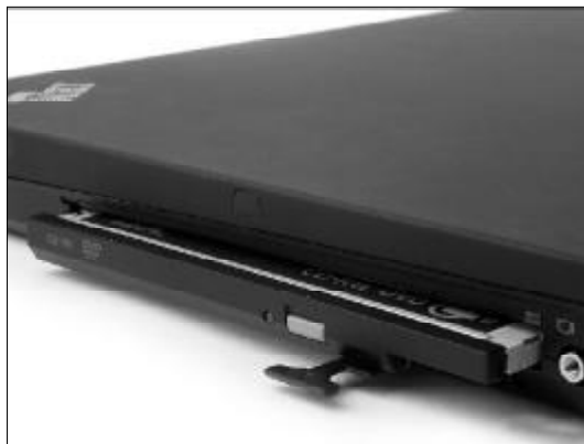
◆图 3-66 笔记本电脑光驱托盘无法弹出
