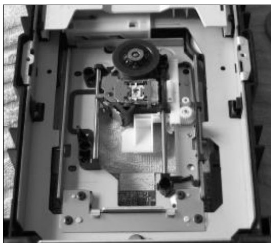
◆图 3-57 笔记本电脑光驱的内部结构
