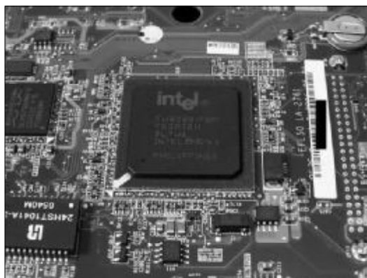
◆图 3-7 南桥芯片损坏会导致 I/O 接口出现问题
