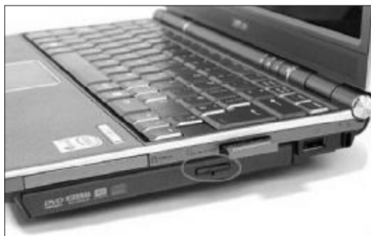
◆图 3-56 用细针插入小孔可强行打开光驱
