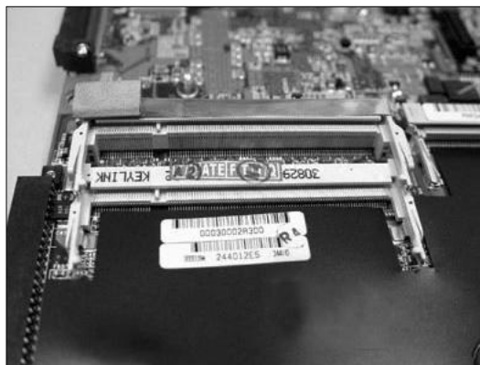
◆图3-41 变形的内存插槽
