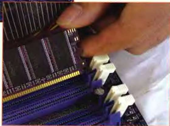
插入内存条的时候注意内存条的两端要插入内存插槽两端的卡子中。
