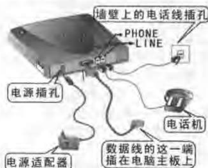
外置串口 MODEM 的连接示意图
