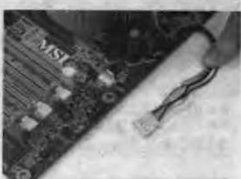
最后，连接风扇电源线。
