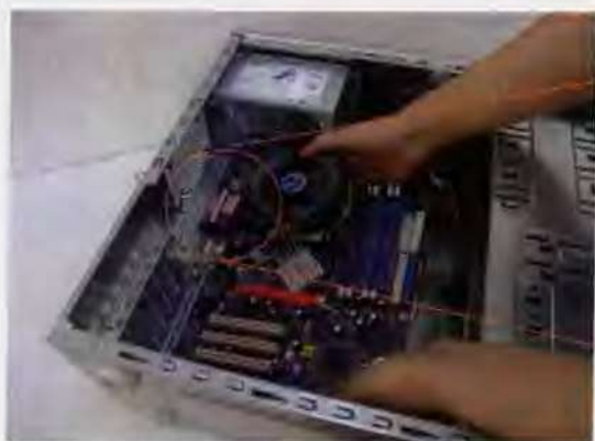
将主板上的I/O接口与机箱背面挡片的孔对齐。
