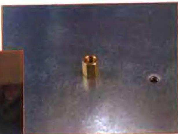
机箱底板上的小铜柱。
