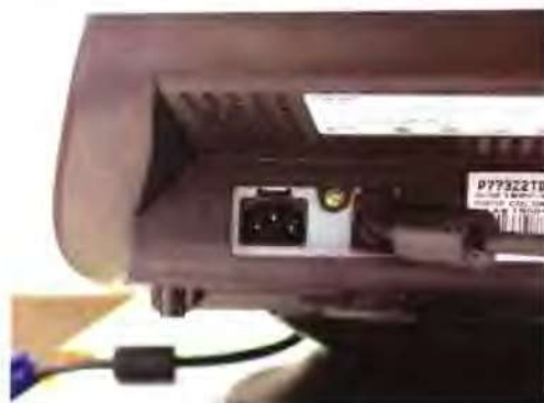
显示器后部的电源插座是三相电源插座。
