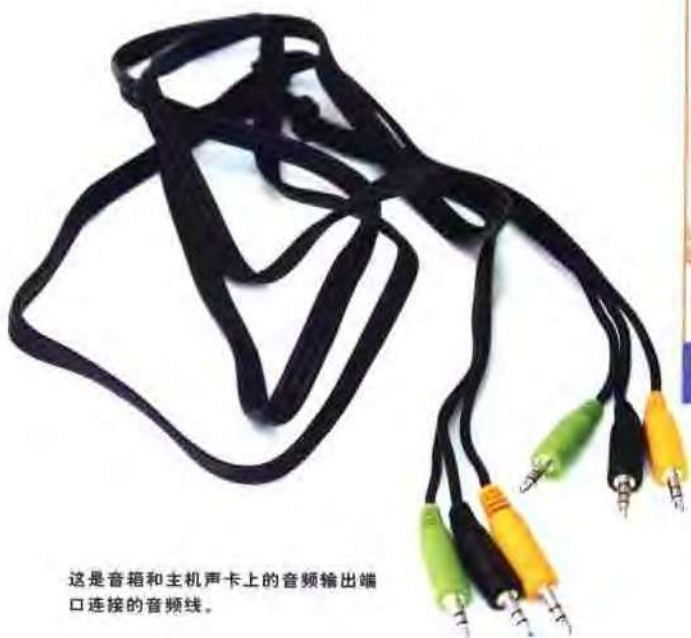
再根据颜色对应或说明书上的提示，将音频线一端插入音箱后部的音频输入接口。
