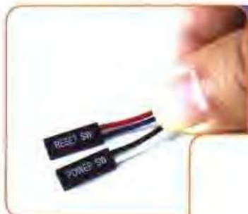
这是机箱上电源开关插头，“POWER SW”为机箱电源开关按钮连线，“RESET SW”为复位按钮连线。
