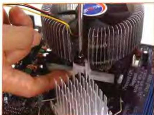
将卡座的另一端稍稍用手抬起，安装好螺丝钉。
