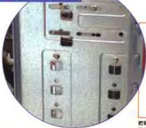
再将另外一颗螺丝钉拧入，同样不要拧得太紧。
