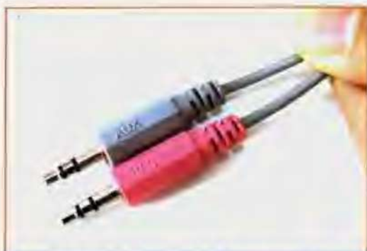
这是前置音频信号连线插头,“AUX”为音频输出线,“MIC”为麦克风输入线。
