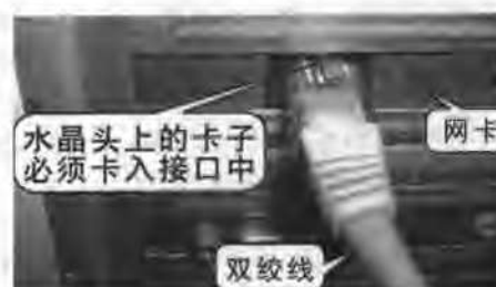
将双绞线的水晶头插入网卡的RJ-45端口中
