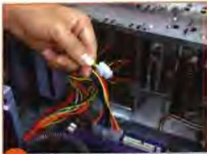
7 再找到一个正方形4孔的电源插头，这是P4 CPU专用电源插头，它的一侧也有卡子。
