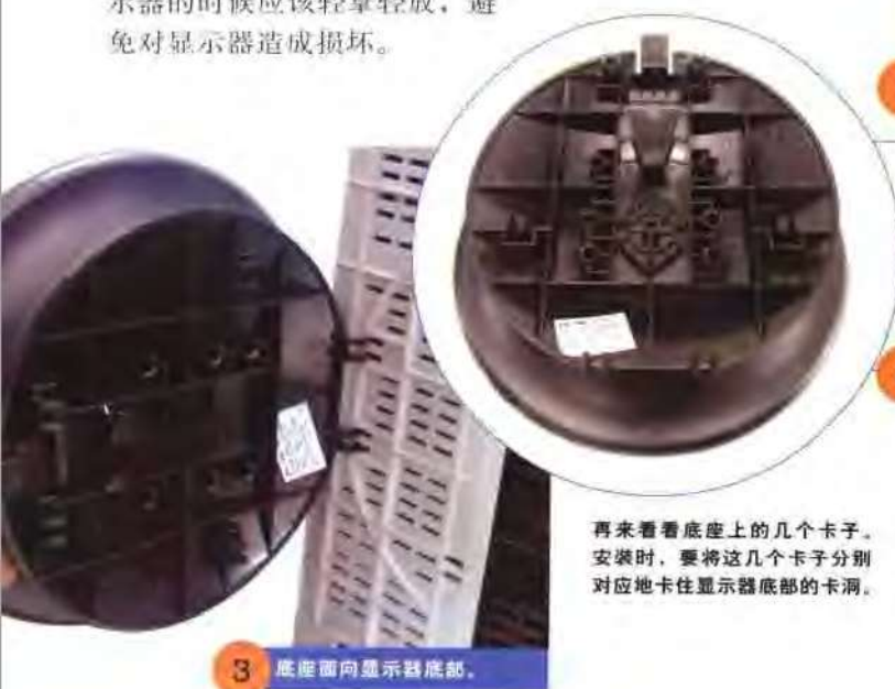
4 首先用手撑住底座，另一支手扶住显示器，准备安装底座。
