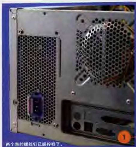
两个角的螺丝钉已经拧好了。
