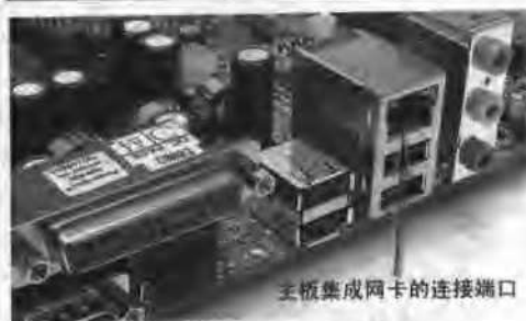
主板集成的网卡所提供的 RJ-45 端口
