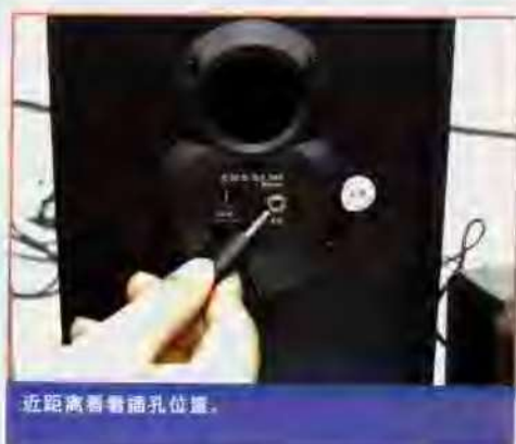
首先将两个高音音箱的音频线插头与低音音箱连接, 插入“音箱”插孔中。
