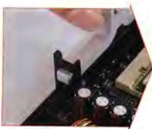
将风扇卡子的另一端插在插槽周围的支架孔中。
