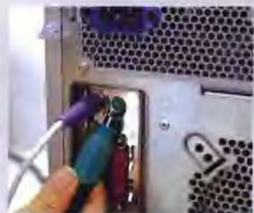
将键盘的接头插入主机上的接口中，同样注意插接头的对应位置要准确。
