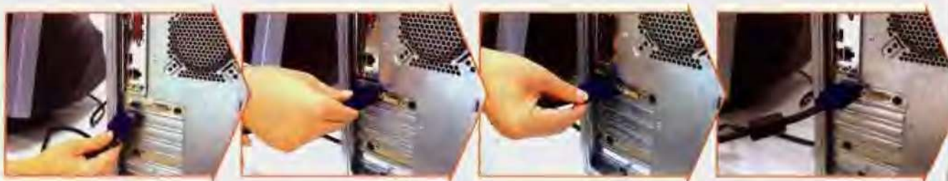
手握插头，准备插在显卡视频输出接口上。——垂直用力将插头插入。——拧紧插头上的螺丝旋钮。——连接好后的状态。
