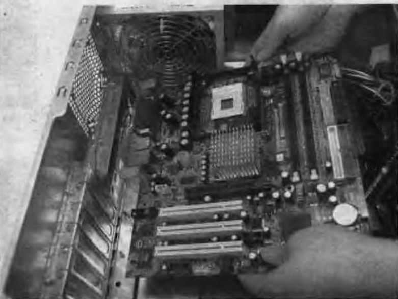
双手将主板托住，斜放入机箱中。
