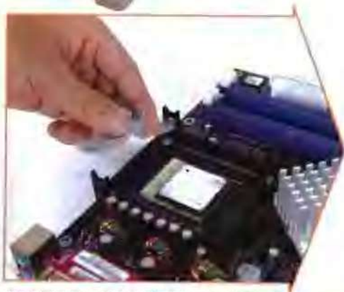
将风扇卡子的一端插入插槽周围的支架孔中。
