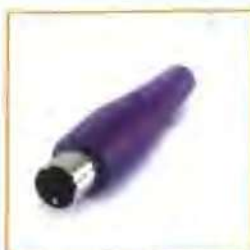
托盘安装好后，应把键盘与主机连接，这是连接主机的PS/2插头。
