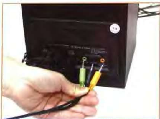
再根据颜色对应或说明书上的提示，将音频线一端插入音箱后部的音频输入接口。
