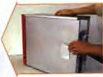
拉出机箱另一面的侧面盖板。
