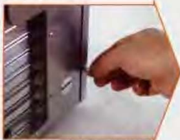
拧下机箱背面右下角的塑料螺丝钉。
