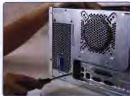
将对角处的螺丝钉拧上。
