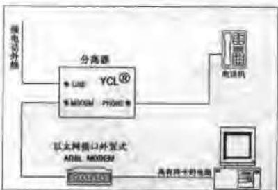
以太网接口的 ADSL MODEM 连接示意图
