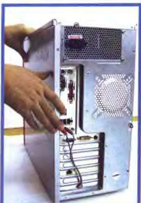
卡好后，用力向机箱前面推，合上面板。
