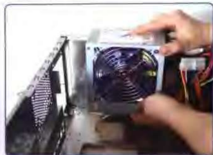
将电源放进机箱中的电源位。
