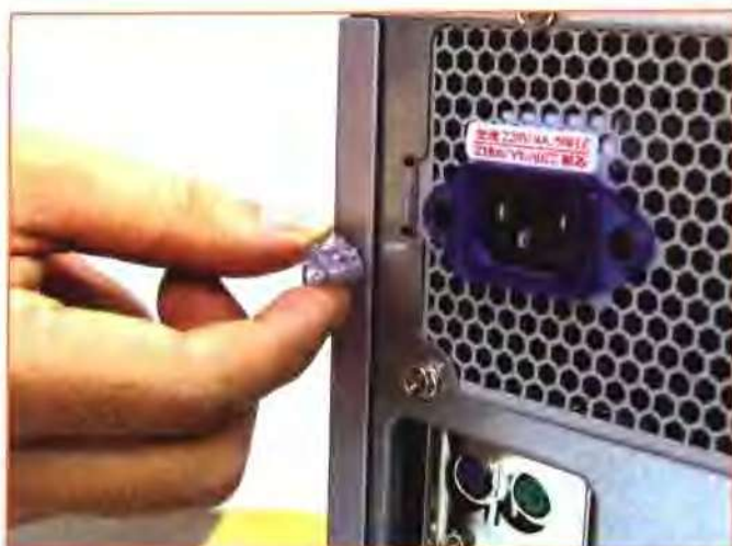
接下来用机箱螺丝钉固定机箱面板。
