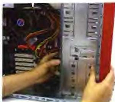
接下来调整硬盘的位置，使固定的硬盘螺丝孔对准机箱托架的螺丝孔。
