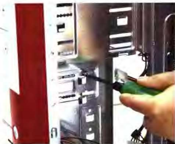
8 拧入软驱另外一侧的两颗螺丝钉，所有的螺丝钉拧紧后即安装完毕。
