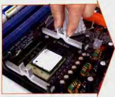
同样在插槽的另一侧也安装好卡子。
