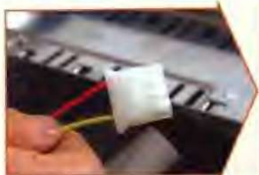
这是硬盘、光驱的电源线插头（也叫D型插头）。只有两根导线，红色对应正极。
