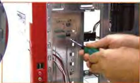
把硬盘托架另外一边的两颗螺丝钉拧上。如果出现螺丝孔错位，可以调整硬盘的位置。
