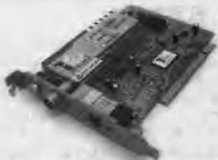
这是一块电视卡，卡上面面积最大的长方形那一部分就叫高频头，电视卡就是通过它来接收天线信号
