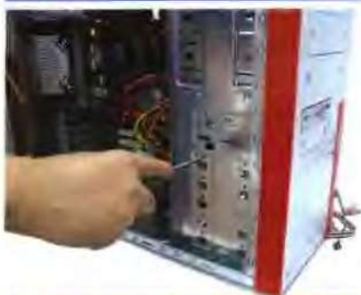
用螺丝刀将一颗螺丝钉拧入，但不要拧得太紧，以免另外3颗螺丝钉的孔错位。
