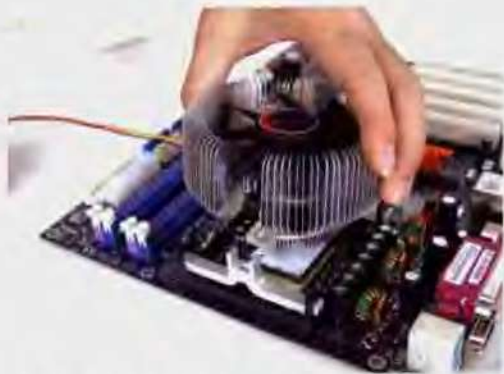
将CPU风扇轻轻放在CPU插槽上。
