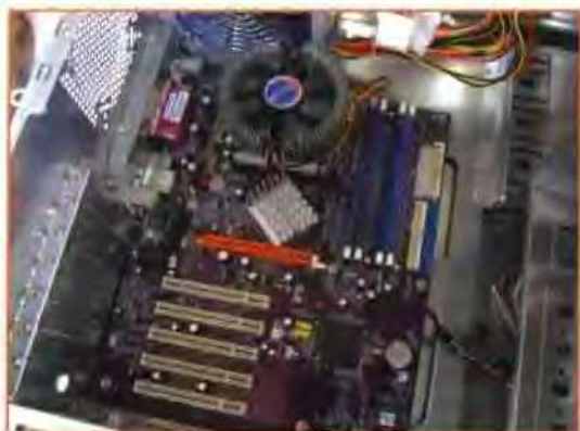
将主板上的螺丝钉全部拧紧。
