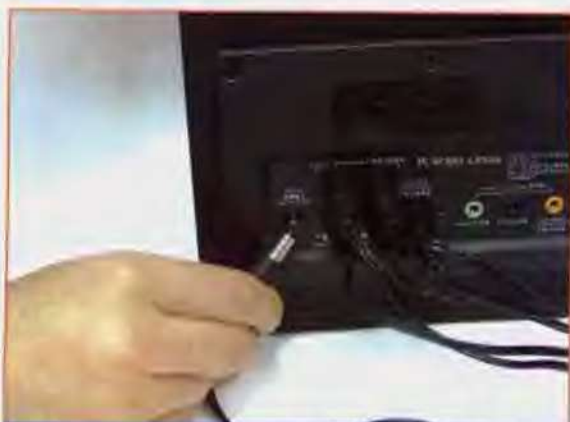
将适配器的圆形插头插入音箱后部的“电源输入”插孔中。
