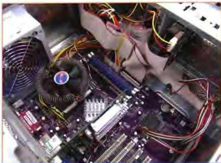
整理好各种线后的状态，明显清爽了很多，也打开了上下通风通道。
