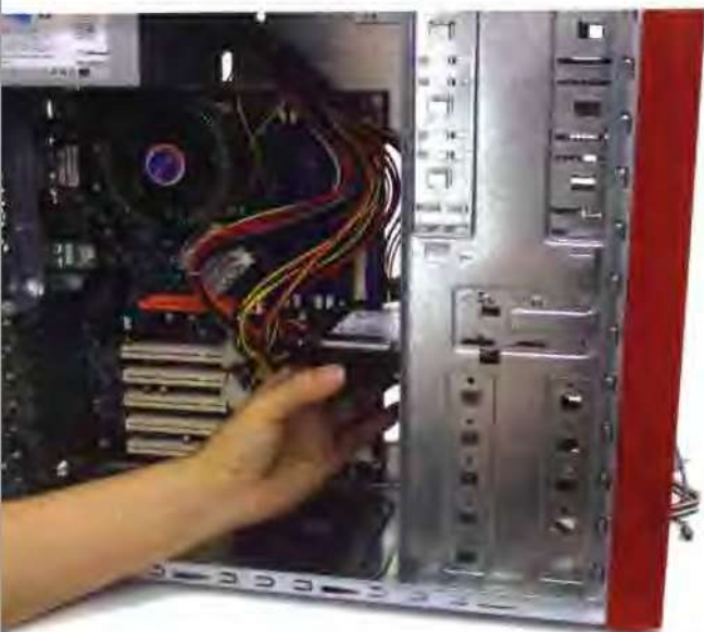
然后将硬盘平稳地放入托架中。
