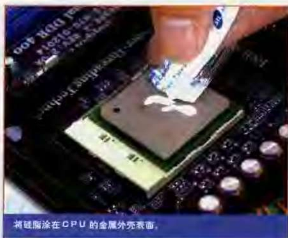
各种类型的硅脂在CPU的金属外壳表面均匀涂上足够的散热膏(硅脂)。但要注意不要涂得太多,只要均匀的涂上薄薄一层即可。
