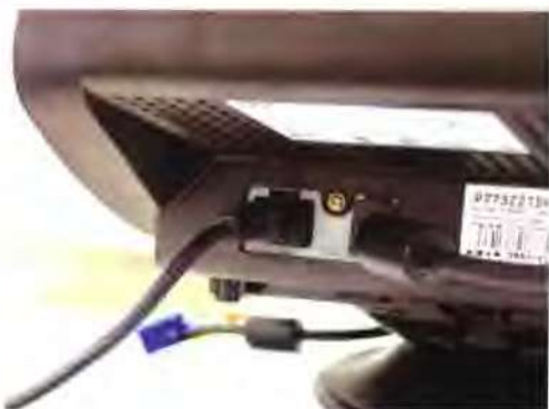
插好后的状态，电源线另一端插入市电插座中，这样显示器就连接好了。
