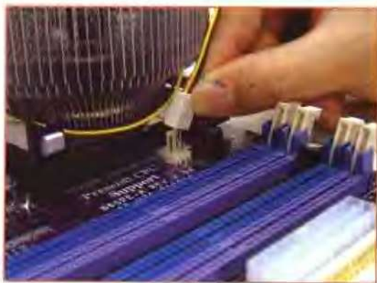
将 CPU 风扇的电源线插头连接到主板上 CPU 风扇电源插座上。
