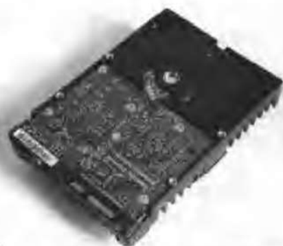
转速高达 10000r/min 的西部数据“猛禽”(Raptor)WD740 硬盘
