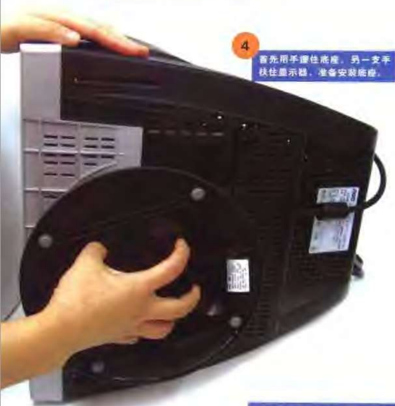
3 底座面向显示器底部。
