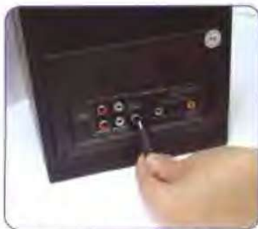
首先将中置环绕音箱的音频插头插入插孔。
