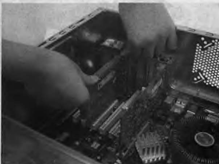
将电视卡垂直插入PCI插槽中。
