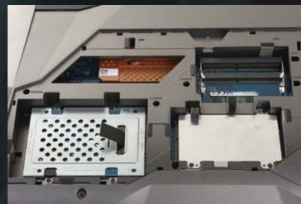
▲ 内部结构，左上的橙色均热板相当醒目。
